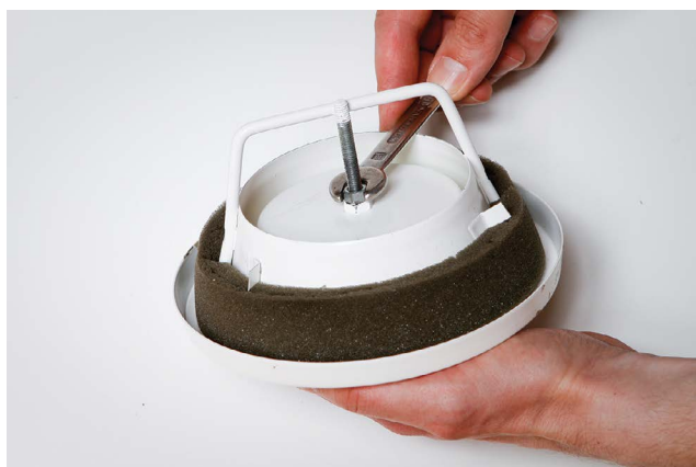
Fig : Bouche bloquée et marquée (nom du local, débit de conception et position de réglage).
