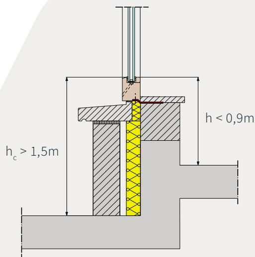
Le choix du type de vitrage (float, verre trempé ou verre feuilleté) dépend de plusieurs paramètres tels que la hauteur de protection, la hauteur de chute, l'espace de part et d'autre du vitrage... Pour ce faire, veuillez vous référer à la série [d'infociches 49](#) basée sur la norme NBN S 23-002.
