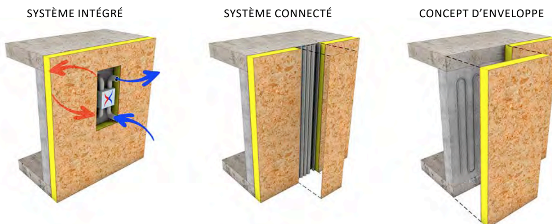
Fig. 50 Les trois niveaux d'intégration des systèmes selon le projet smartTES (adapté de Lattké) [75].
