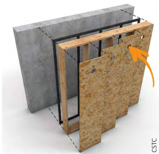
Fig. 40 Trous destinés à l'injection d'isolant en vrac après l'assemblage sur chantier.
