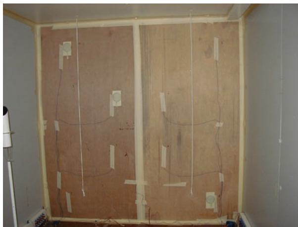
Afb. 20 Foto van de beproefde component, genomen in de PASLINK-cel.
