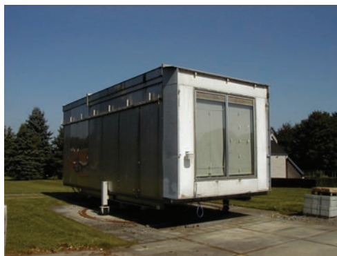
Afb. 9 PASLINK-buitentestcel (proef op een doorschijnende component).
