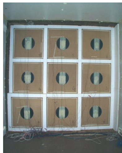
Afb. 12 Foto van de negen componenten, genomen in de PASLINK-cel.
