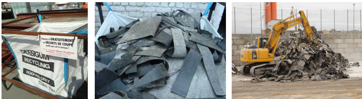
Fig. 60 Récupération et collecte d'étanchéités bitumineuses (source : Derbigum & CSTC) [119].
