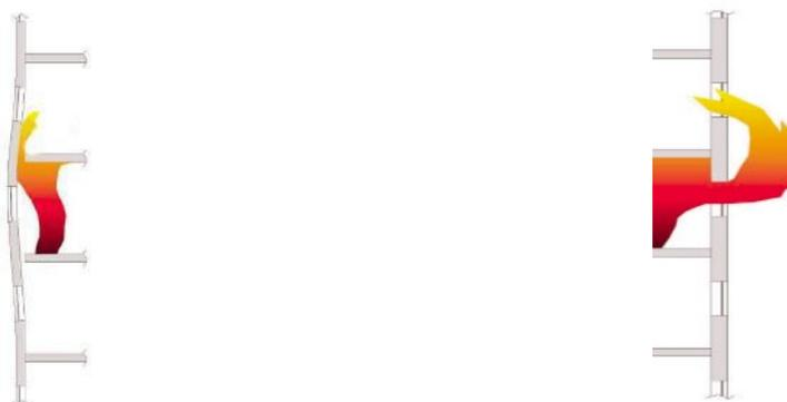
Figure 16 – Propagation interne de l'incendie (à gauche) et propagation externe de l'incendie (à droite).
