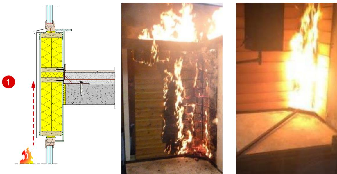
Figure 9 – Propagation de l'incendie par la surface du revêtement de façade (à gauche) – Essais de réaction au feu sur un bardage en bois (au centre et à droite).
