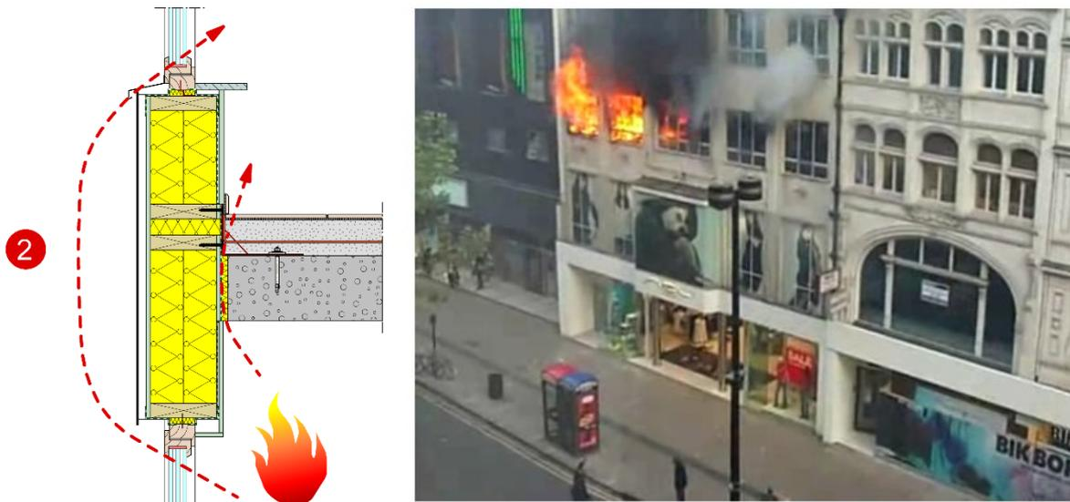
Figure 10 – Propagation interne et externe de l'incendie. À gauche : schéma de principe; à droite : flammes sortant d'un étage en feu.
