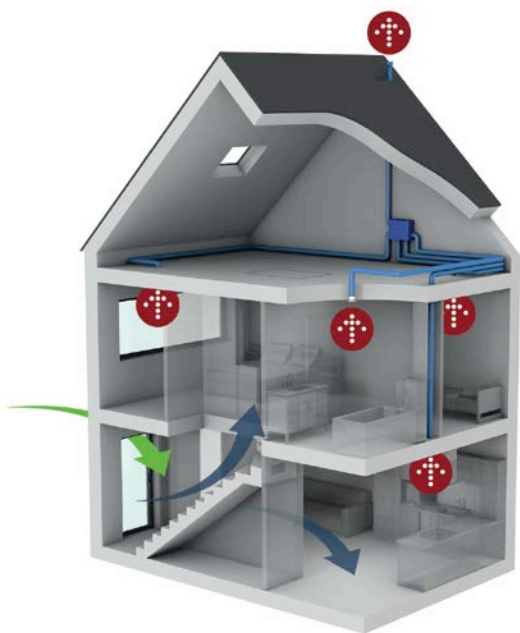
Fig. 16B Schéma 3D du système C hall centralisé dans une maison à deux étages.
