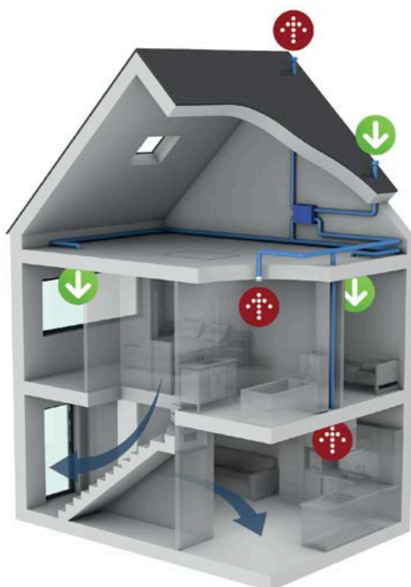
Fig. 10 Schéma 3D du système D cascade dans une maison à deux étages.
