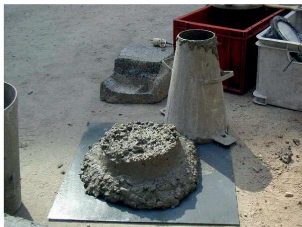
Fig. 1 Essai d'affaissement (*slump*).
