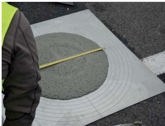
Fig. 4 Mesure de l'étalement au cône d'Abrams (*slump flow*).
