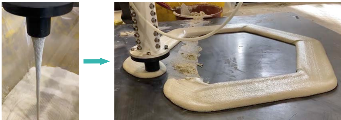
Fig. 37b Essais d'impression 3D réalisés chez Buildwise. Mélange jugé trop fluide (affaissement élevé, mélange non constructible).
