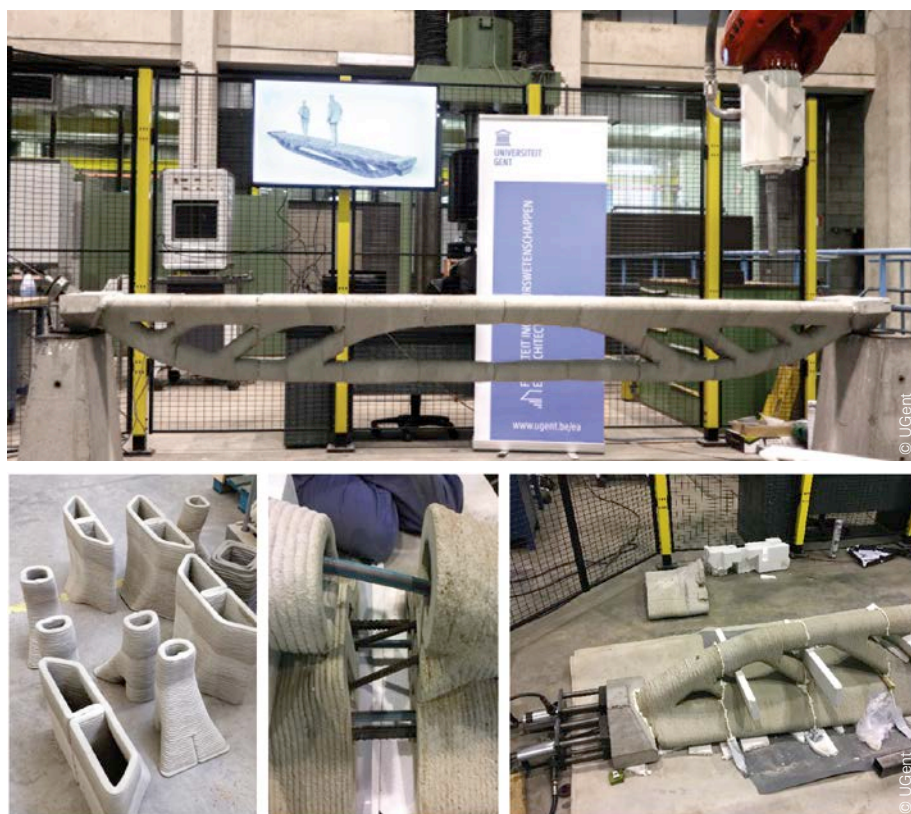
Fig. 32 Étapes de renforcement d'un pont imprimé par des câbles de précontrainte.
