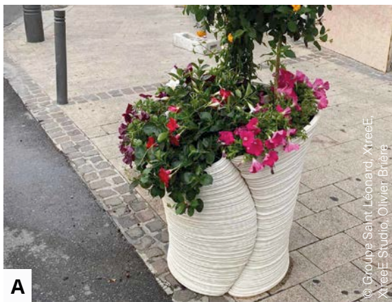
Fig. 52b Pièces imprimées par Buildwise et installées dans son bâtiment à Zaventem. Cache-pot de 1,1 mètre de diamètre (gauche) et pied de table (droite).
