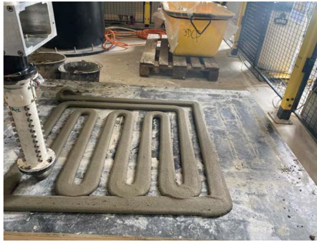
Fig. 18 Impression d'un mortier à base de sable recyclé belge fourni par le centre de recyclage des déchets inertes RECYMEX (essai effectué chez Buildwise en collaboration avec l'ULiège).
