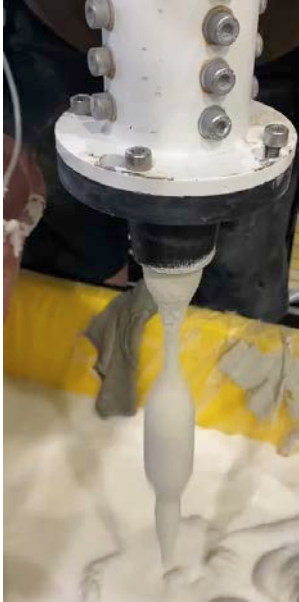
Fig. 38 Principe du Slugs-test pour déterminer le seuil d'écoulement du mortier.
