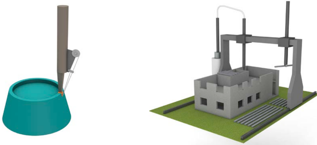
Fig. 4 Processus du Contour Crafting (gauche) et principe de la construction à grande échelle avec ce procédé (droite) [K1].
