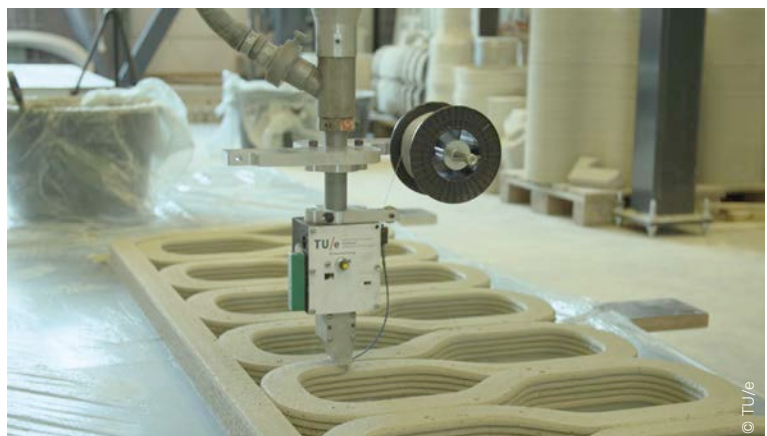
Fig. 23 Renforcement continu durant l'impression. Schéma de principe (gauche, [M1]) et renforcement avec des câbles métalliques (droite).
