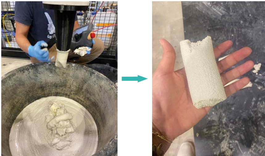
Fig. 37d Essais d'impression 3D réalisés chez Buildwise. Mélange jugé trop ferme (non extrudable).
