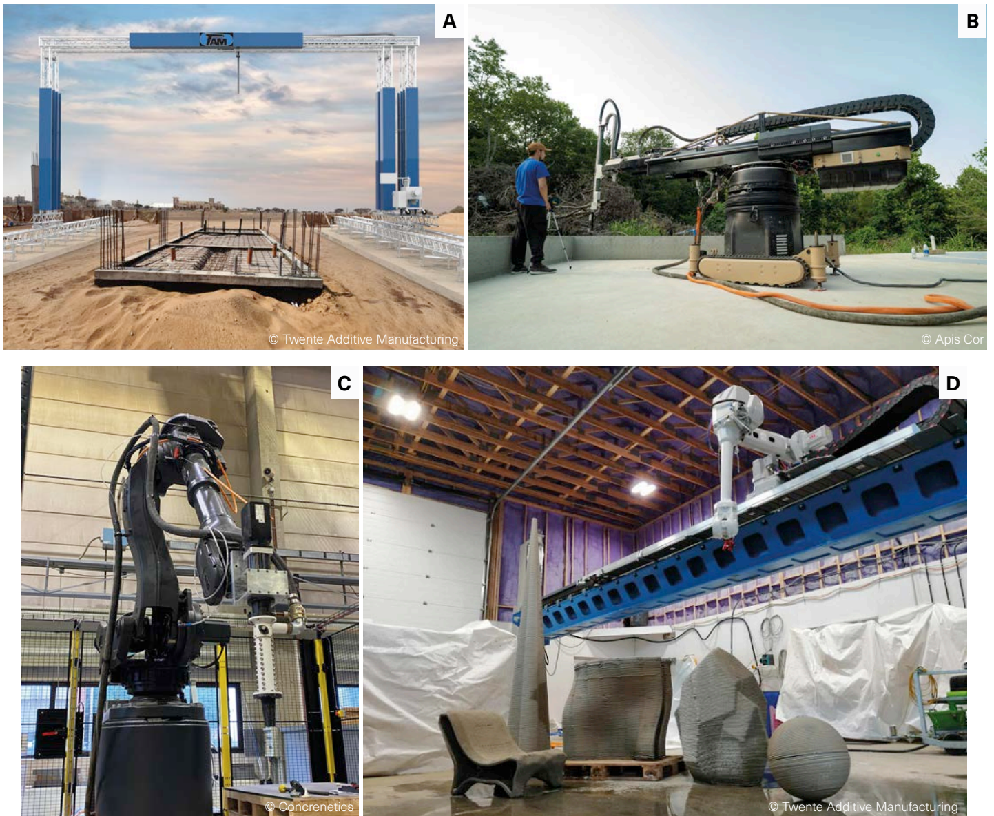
Fig. 6 Machine à portique (A), machine à leviers (B), machine à bras robotisé à six axes (C) et imprimante à neuf axes avec robot placé sur un portique (D).
