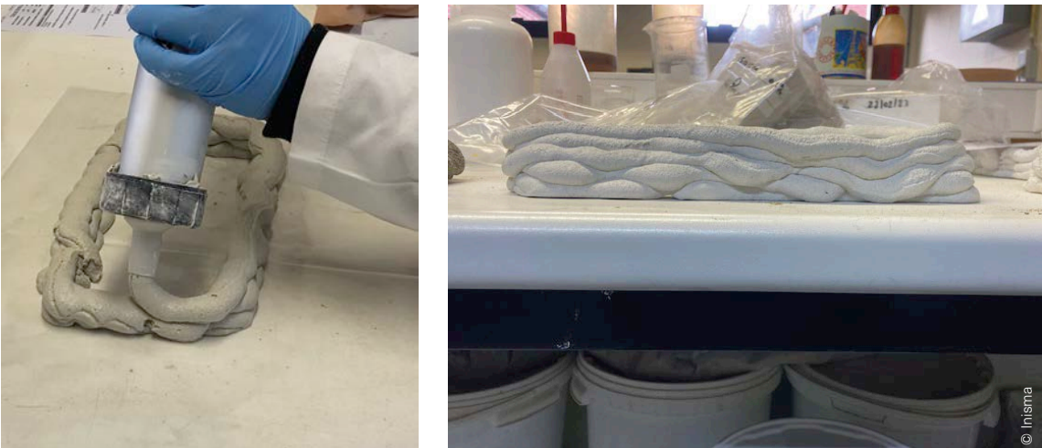
Fig. 39 Pistolet à silicone utilisé pour tester l'extrudabilité du mélange imprimable (gauche) et exemple de couches imprimées par ce pistolet (droite).
