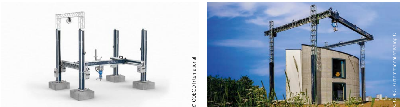
Fig. 46 Imprimante BOD2 (gauche) et maison imprimée par la BOD2 chez Kamp C (droite).
