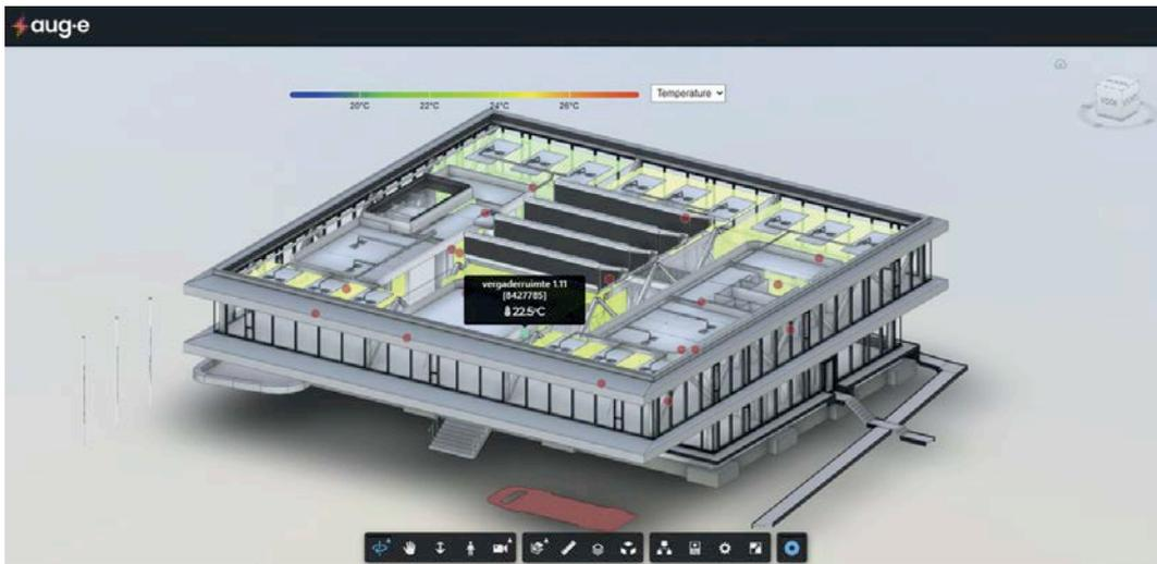
**Fig. 20** Exemple de jumeau numérique dans la plateforme aug-e, issue d'une collaboration entre les entreprises BESIX, Proximus et i.Leco.
