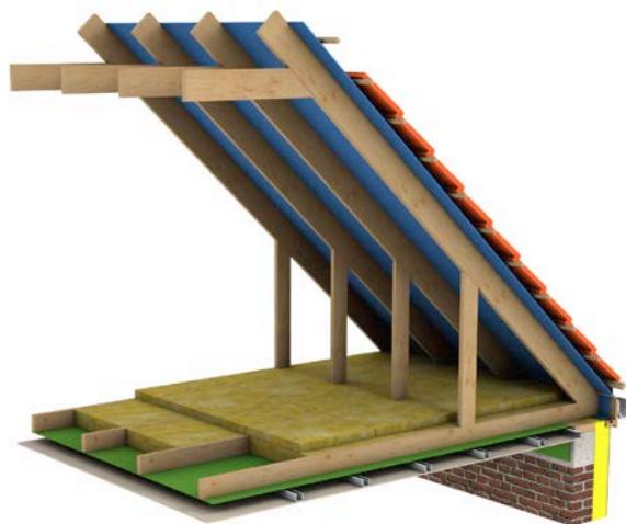
Fig. 2 Cas d'une isolation par le bas (vue 3D).
