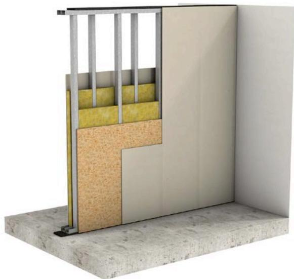
Fig. 1 Cloison double à ossature métallique (vue 3D).
