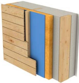
Fig. 1 Ossature en bois, application depuis l'intérieur (vue 3D).
