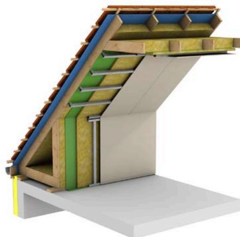
Fig. 2 Isolation semi-rigide entre et sous fermettes (vue 3D).
