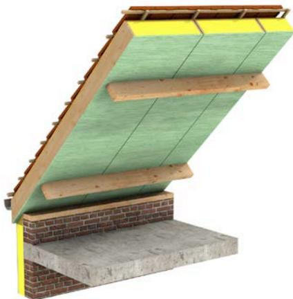
Fig. 1 Isolation de toitures à l'aide de caissons préfabriqués :
