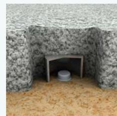
Un volume de sécurité doit être défini autour des **conduits de fumées** par un arrêtoir rigide. Il doit se trouver à 15 cm au moins du conduit, et avoir une hauteur qui dépasse de 10 cm le haut de l'isolant. [NBN B 61-002] (voir [FAQ p. 144](#)).
