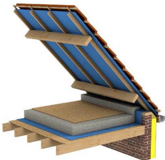
Fig. 1 Chape sur plancher en bois (vue 3D).
