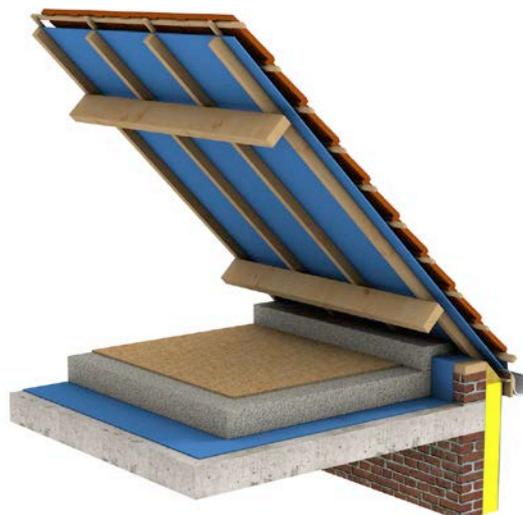
Fig. 2 Chape sur plancher en béton (membrane généralement superflue)
