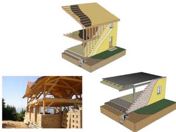
Fig. 1 Blocs isolants autoportants et structure poteaux-poutres ou ossature en bois (source : Chanvribloc).
