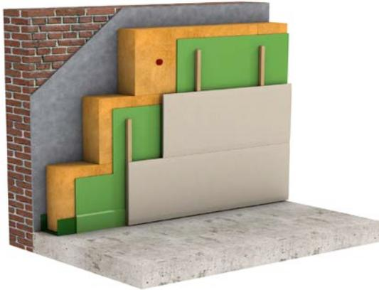
Fig. 1 Isolation des murs par l'intérieur – panneau de finition (vue 3D).
