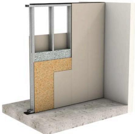
Fig. 1 Ossature métallique double (vue 3D).
