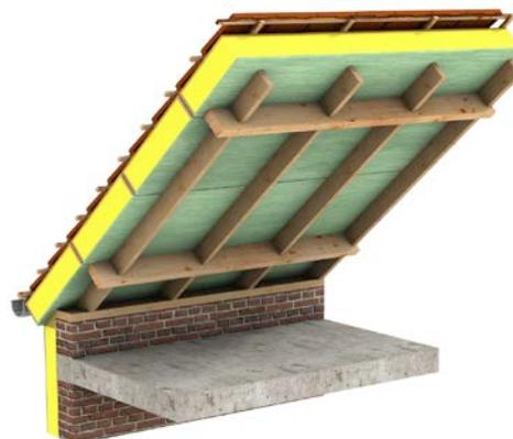
Fig. 2 Isolation de toitures à l'aide de caissons préfabriqués :
