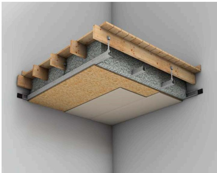
Fig. 1 Plafond suspendu avec boîtiers acoustiques (vue 3D).
