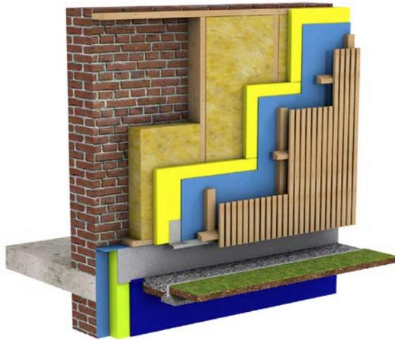
Fig. 1 Isolation semi-rigide et rigide et bardage ajouré (vue 3D).
