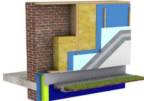
Fig. 2 Isolation semi-rigide (vue 3D).
