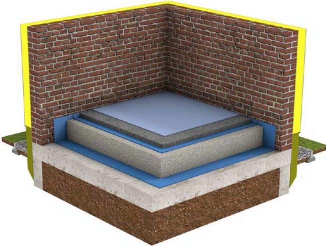
Fig. 1 Isolation au-dessus d'un terre-plein (vue 3D).
