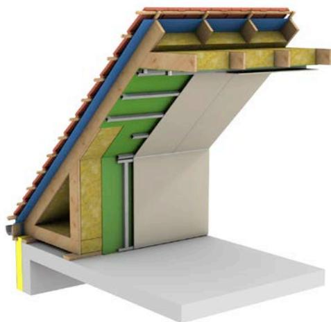
Fig. 1 Isolation semi-rigide entre fermettes (vue 3D).
