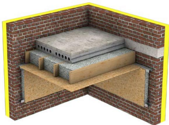
Fig. 1 Isolation de la face inférieure du plancher et des murs à l'aide d'un isolant en vrac (vue 3D).
