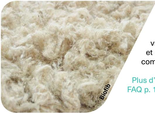
L'ouate de chanvre est un mélange de fibres de chanvre courtes et de fibres de coton, traitées pour augmenter la résistance au feu. L'ouate de chanvre en vrac est uniquement mise en œuvre par **soufflage** pour l'isolation des planchers et des combles perdus. L'isolation en vrac permet un remplissage complet des compartiments dans les endroits difficilement accessibles.
