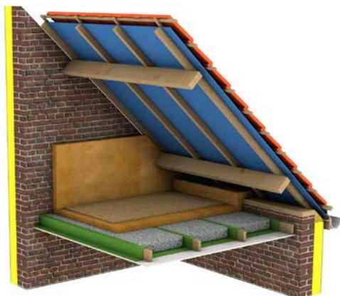
Fig. 1 Isolants rigides et en vrac, cas d'une isolation par le haut (vue 3D).
