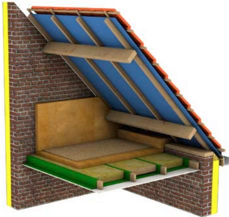
Fig. 1 Isolants semi-rigides et rigides. Isolation par le haut (vue 3D).
