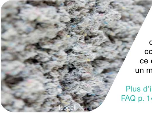
La ouate de cellulose est obtenue à partir du recyclage de papier broyé, défibré, puis malaxé et traité. Cette fiche décrit le cas où la ouate est projetée dans des cavités ouvertes. L'isolation par projection humide assure un remplissage complet et homogène des parois autour des gaines électriques et des conduites, ce qui permet de limiter les ponts thermiques. Une fois sèche, la ouate devient un matériau rigide.
