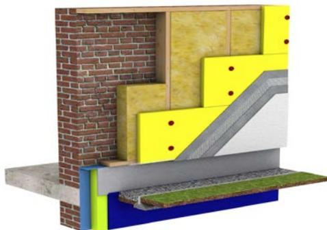
Fig. 1 Isolation semi-rigide et rigide (vue 3D) (valable uniquement pour des panneaux d'une épaisseur supérieure à 6 cm et résistants au vent).
