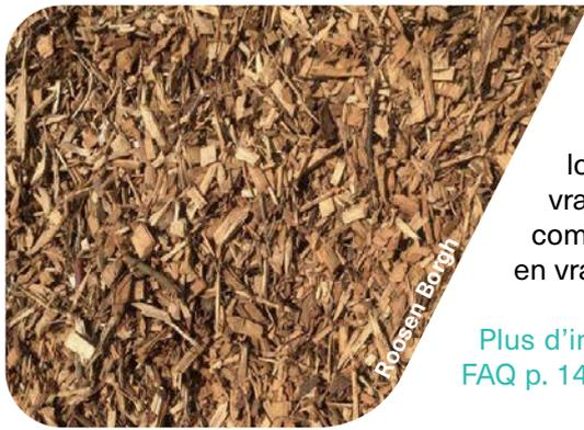
Les copeaux de bois sont des sous-produits de scierie, auxquels on peut ajouter des additifs pour augmenter certaines propriétés. Matériau disponible localement et donc très peu onéreux, il peut être mis en œuvre par **épannage** en vrac pour des isolations de combles. L'isolation en vrac permet un remplissage complet des compartiments dans les endroits difficilement accessibles. L'épannage en vrac des copeaux de bois n'est pas soumis à des règles professionnelles.
