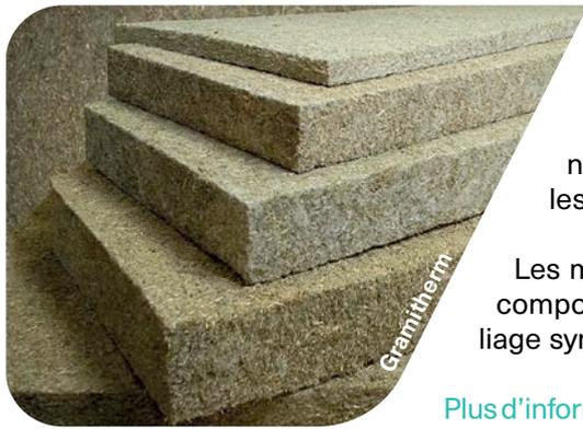
Aussi appelés isolants souples, les matelas d'herbe servent d'isolation entre ossatures dans de multiples applications. Ils s'adaptent bien aux irrégularités et peuvent être utilisés aussi bien en rénovation que pour les constructions neuves. Ils se posent simplement comme les autres laines du marché. Seuls les matelas provenant de fabricants officiels peuvent être employés.
