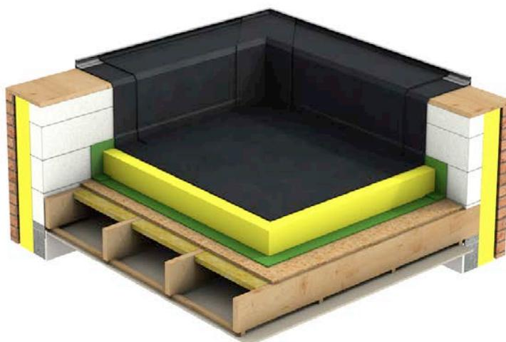
Fig. 1 Isolation d'une toiture plate 'duo' au moyen d'isolants semi-rigides et rigides (vue 3D).
