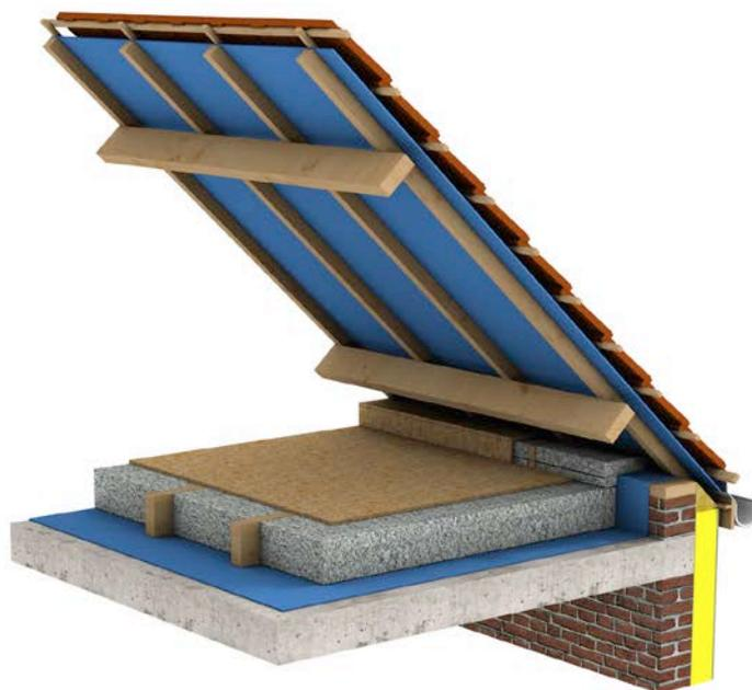
Fig. 1 Planchers de combles en béton avec isolants en vrac (possibilité de stockage) (vue 3D).
