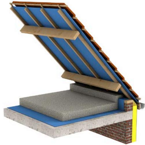
Fig. 2 Chape sur plancher en béton (membrane généralement superflue) (vue 3D).
