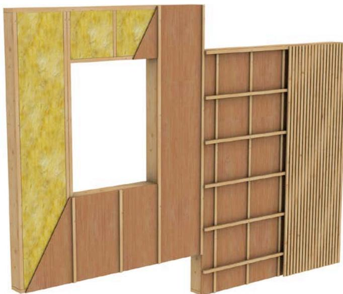
Fig. 1 Mur en caissons préfabriqués (vue 3D).
