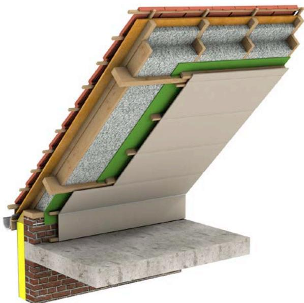
Fig. 1 Isolation par insufflation entre et sous les chevrons avec contre-chevonnage (vue 3D).
