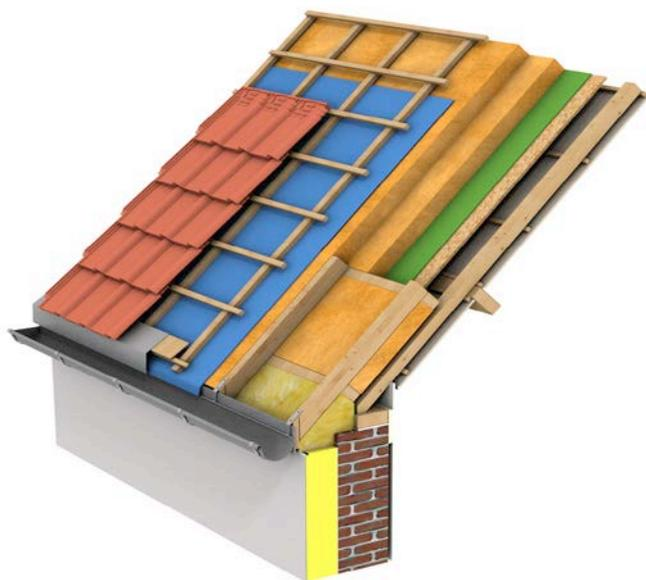
Fig. 1 Toiture sarking avec plancher de toiture (vue 3D).
