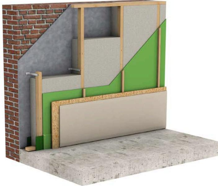
Fig. 1 Isolation des murs par l'intérieur par projection humide (vue 3D).
