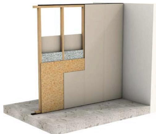
Fig. 2 Ossature en bois simple (vue 3D).
