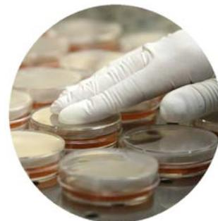
Fig. 1 Test de sensibilité aux moisissures selon la norme NBN EN ISO 846.
