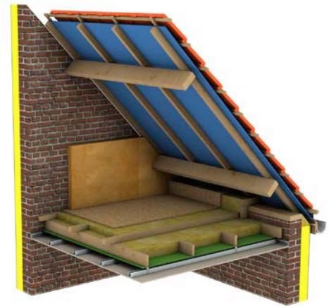
Fig. 2 Isolants semi-rigides. Isolation par le bas (vue 3D).
