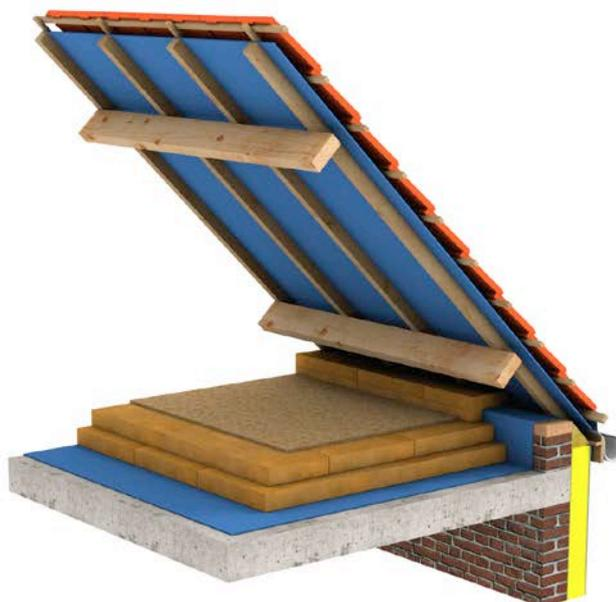
Fig. 1 Plancher de combles en béton avec isolant rigide (possibilité de transformer les combles en un espace de stockage) (vue 3D).
