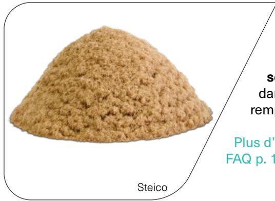
Les fibres de bois sont fabriquées à partir de copeaux de résineux (sous-produits de scierie) broyés puis traités. Les fibres de bois sont mises en œuvre par **soufflage** sur des surfaces horizontales (planchers, combles) ou par **insufflation** dans des cavités fermées (murs, toitures, caissons). L'isolation en vrac permet un remplissage complet des compartiments dans les endroits difficilement accessibles.
