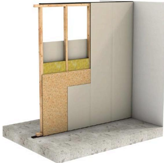
Fig. 2 Cloison simple à ossature en bois (vue 3D).
