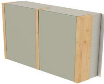
Fig. 3 Ossature en bois, application depuis l'extérieur (vue 3D) (s'assurer d'une épaisseur extérieure supérieure à 60 mm et d'un retrait suffisamment faible).
