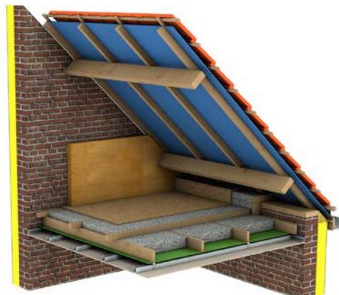
Fig. 2 Isolants en vrac, cas d'une isolation par le bas (vue 3D).
