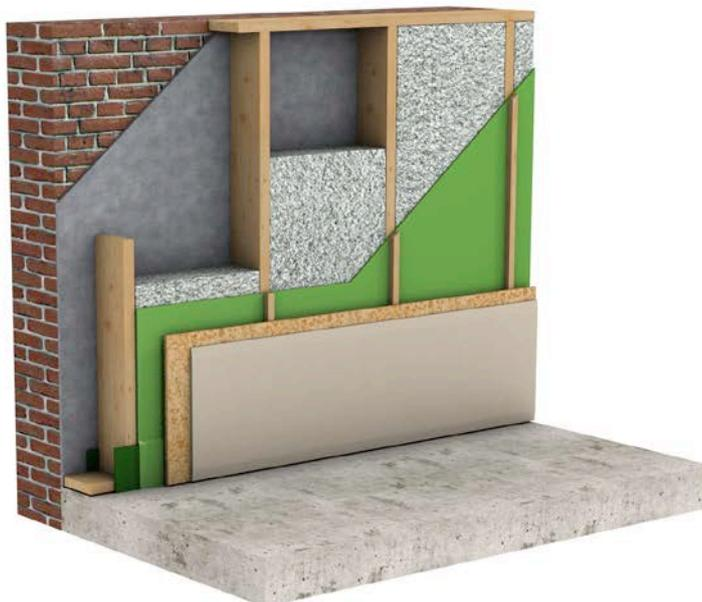
Fig. 1 Isolation des murs par l'intérieur par insufflation (vue 3D).
