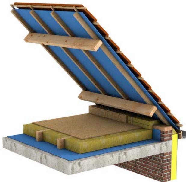
Fig. 1 Isolation de combles accessibles en béton à l'aide d'un isolant semi-rigide (vue 3D).
