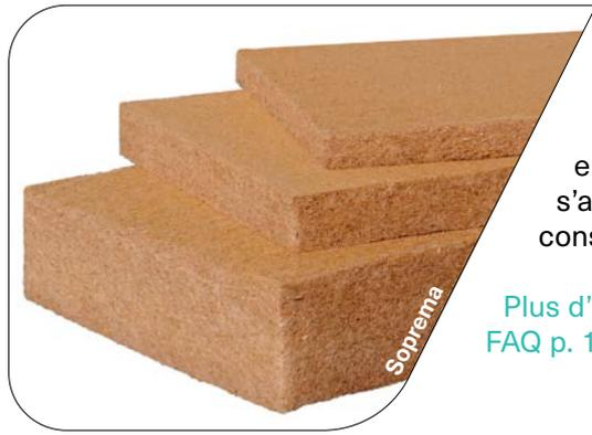
Les matelas en laine de bois sont façonnés à sec à partir de fibre (obtenues par défibrage du bois) et d'un liant. Aussi appelés isolants souples, les matelas en laine servent d'isolation entre ossatures dans de multiples applications. Ils s'adaptent bien aux irrégularités et peuvent être utilisés tant en rénovation qu'en construction neuve. Ils se posent simplement comme les autres laines du marché.
