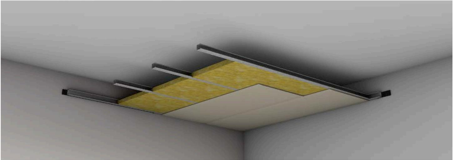
Fig. 1 Plafond suspendu autoportant.
