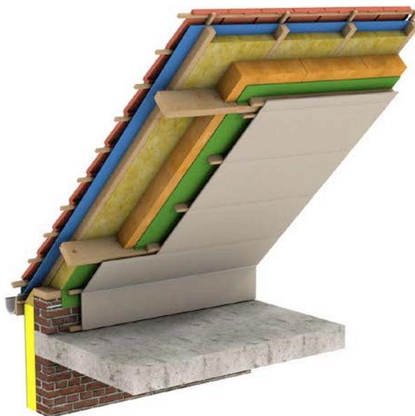
Fig. 1 Isolation d'une toiture par l'intérieur au moyen d'un isolant semi-rigide et d'un isolant rigide (vue 3D).
