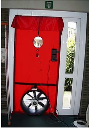
Figure 8 : Porte soufflante pour l'essai de pressurisation du bâtiment
