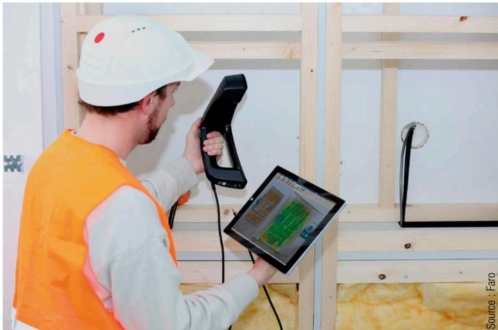
Fig. 18 Scanner 3D par caméra à temps de vol produisant une acquisition en temps réel pour les espaces intérieurs.
