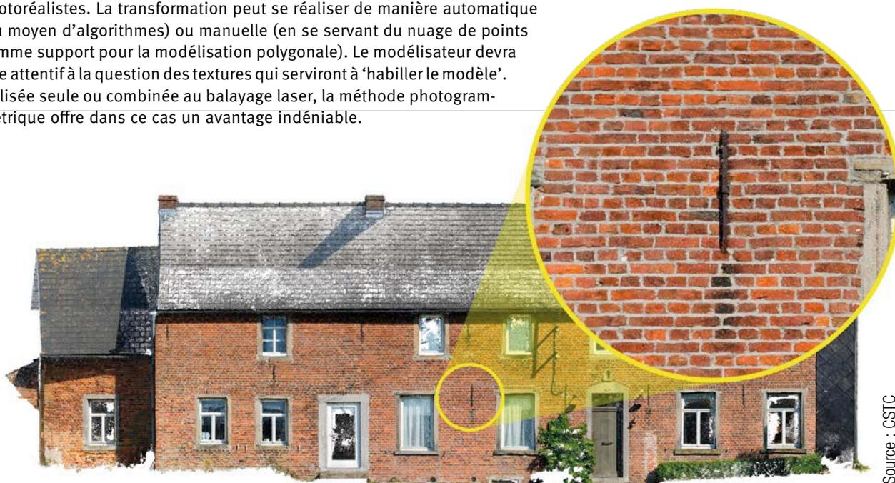
Fig. 33 Orthovue d'un nuage de points de très haute résolution issu de la méthode photogrammétrique.
