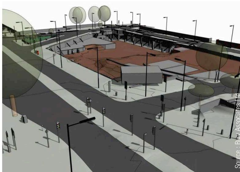
Fig 22 Modéliser une maquette topographique BIM à partir d'un relevé au scanner laser.
