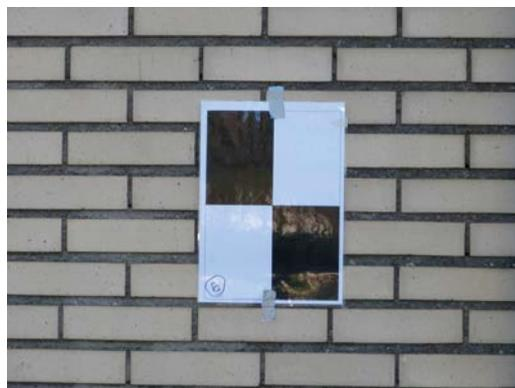
B. Exemple d'une cible utilisée dans le processus de calage
