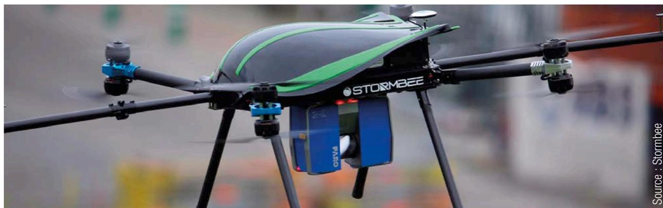
Fig. 47 Premières solutions 'compactes' pour la lasergrammétrie embarquée sur drone.
