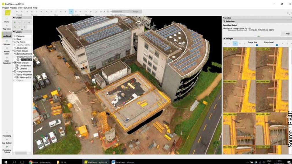
Fig. 45 Suivi de chantier par une campagne de numérisation étalée dans le temps (relevé par drone) avec possibilité de comparaison à la maquette BIM d'exécution.
