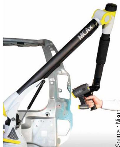
Fig. 17 Scanner 3D par triangulation active pour la numérisation en environnement contrôlé.
