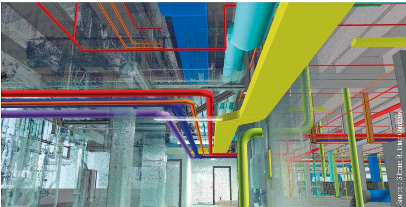
Fig. 29 Préfabrication de systèmes HVAC sur la base d'un nuage de points.
