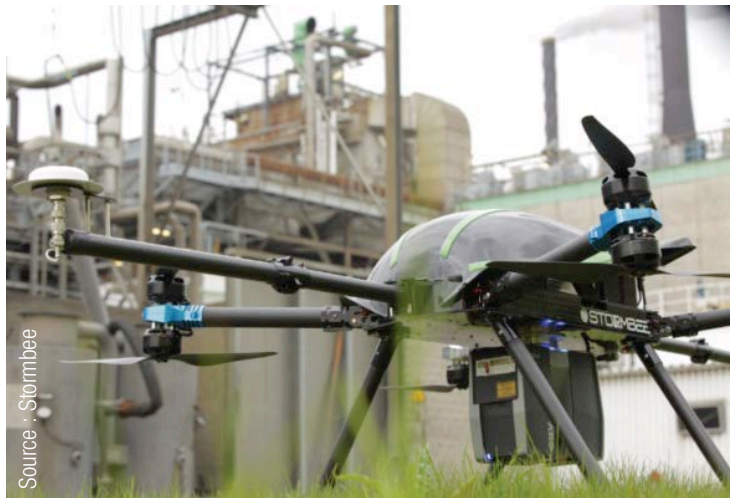
Fig. 39 Drone belge qui permet au scanner laser de prendre les airs.
