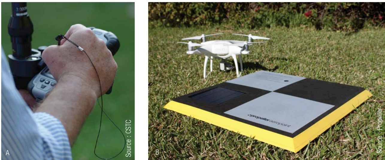
Fig. 38 Référencement spatial des relevés. A. Collecte manuelle de points GPS. B. Une cible intelligente.
