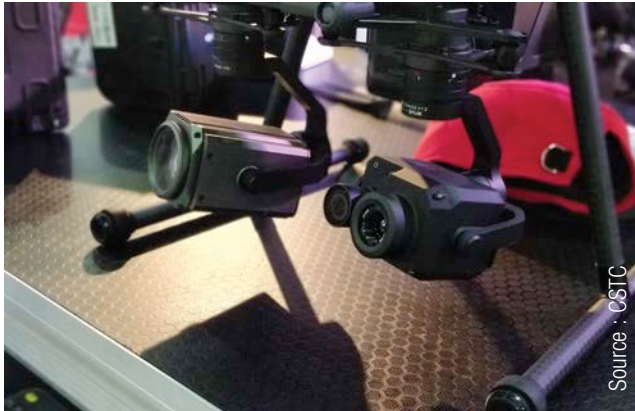
Fig. 21 Drone équipé de deux outils différents : une caméra munie d'un zoom et une caméra thermique.
