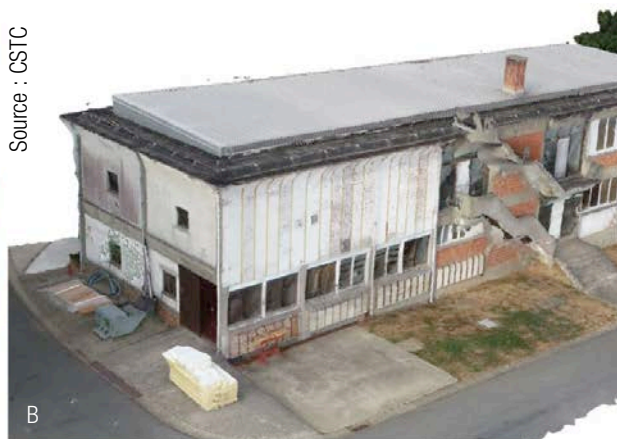
Fig. 36 Deux reconstructions 3D très différentes selon le protocole de prise de vue suivi. A. Uniquement des photographies NADIR. B. Combinaison de photographies NADIR et de photographies obliques.
