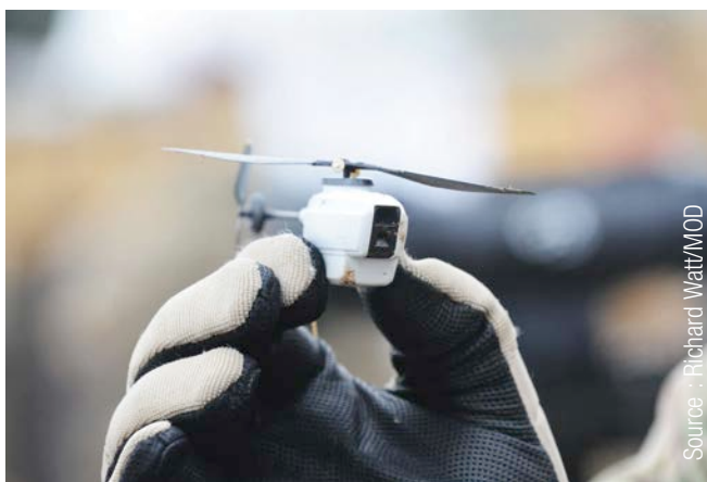
Fig. 2 Le 'Black Hornet Nano', un drone miniature rendu possible grâce aux évolutions de l'électronique.
