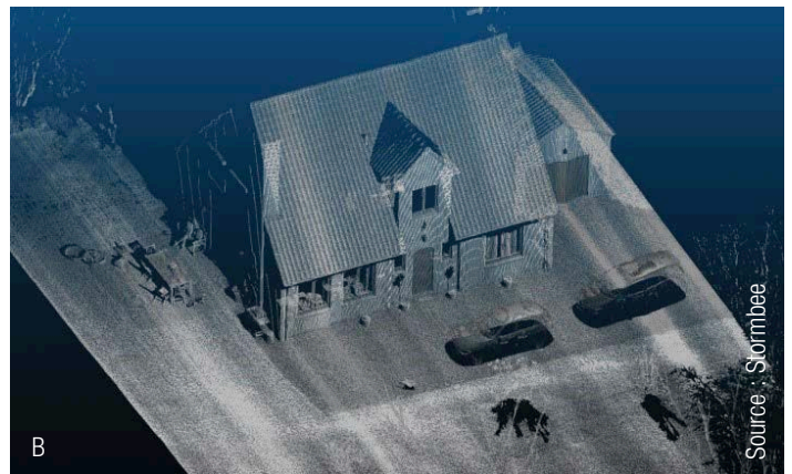
Fig. 40 L'utilisation d'un scanner laser monté sur un objet en mouvement impose de corriger les mesures. A. Résultat du relevé par scanner laser aéroporté sans correction. B. Même scan après correction.
