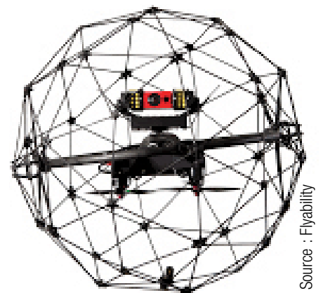
Fig. 27 Sphère de protection permettant au drone de se mouvoir dans des espaces confinés.
