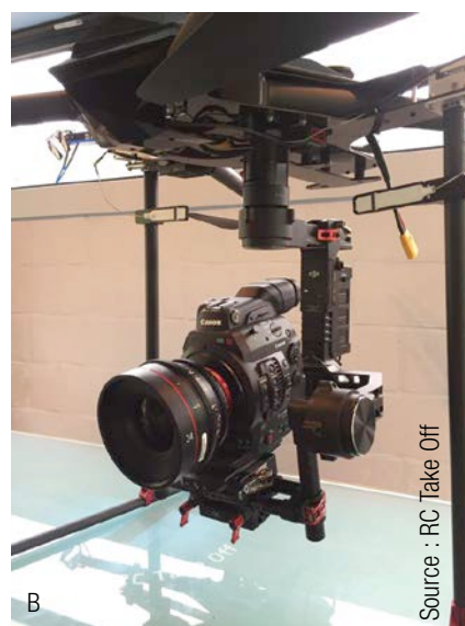
Fig. 16 Il existe une grande variété de nacelles, ces dispositifs qui portent la caméra et assurent sa stabilité. A. Combinaison nacelle/caméra intégrée sous le drone. B. Nacelle professionnelle pouvant embarquer une très lourde caméra cinématographique et se fixant sous le drone.
