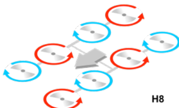
Fig. 7 Configurations fréquentes des hélices des multicoptères. Le sens de rotation des hélices est indiqué par une flèche colorée.
