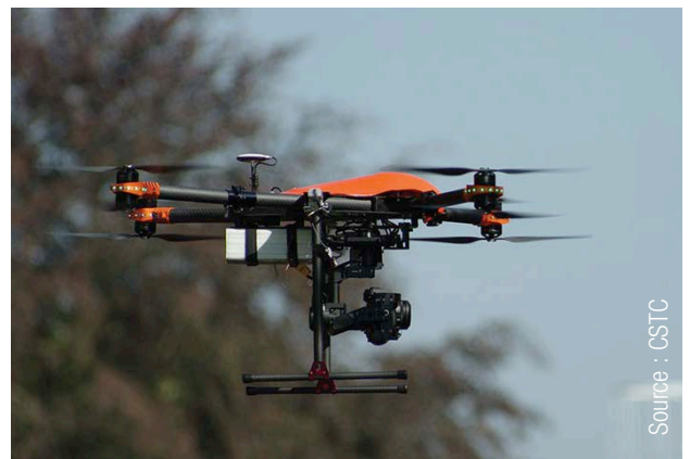
Fig. 4 Utilisation d’un drone pour le relevé photogrammétrique d’un bâtiment.
