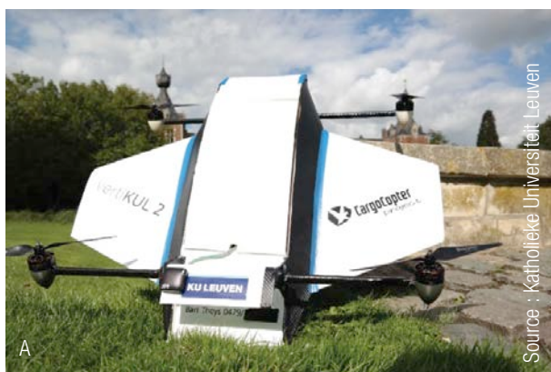
Fig. 10 Il existe de nombreux types de drones qui ne sont pas à proprement parler des voilures fixes ou des voilures tournantes. A. Drone hybride combinant une haute vitesse de déplacement avec la capacité de décoller à la verticale. B. Le biomimétisme au travers d'un drone 'ornithoptère'.
