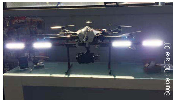
Fig. 25 Eclairage de grande puissance facilitant l'inspection de nuit.
