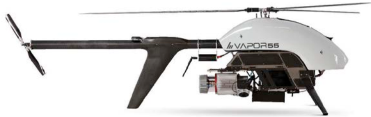
Fig. 6 L'hélicoptère est un sous-type de drone à voilure tournante. Le rotor de queue évite que l'appareil ne se mette à tourner sur lui-même.
