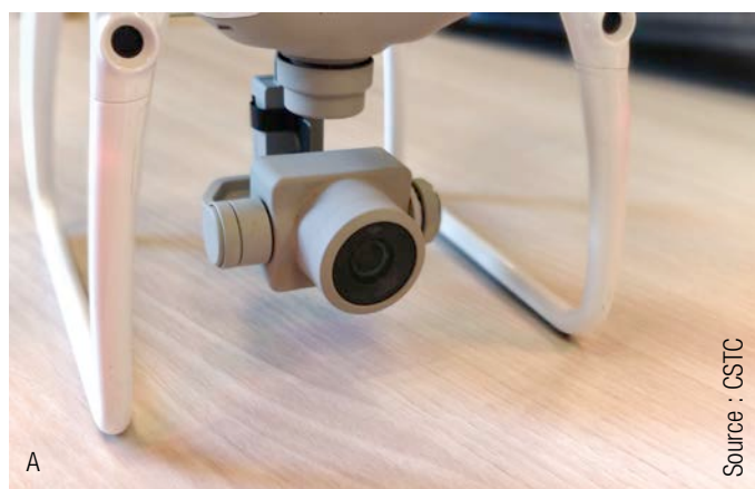
Fig. 16 Il existe une grande variété de nacelles, ces dispositifs qui portent la caméra et assurent sa stabilité. A. Combinaison nacelle/caméra intégrée sous le drone. B. Nacelle professionnelle pouvant embarquer une très lourde caméra cinématographique et se fixant sous le drone.
