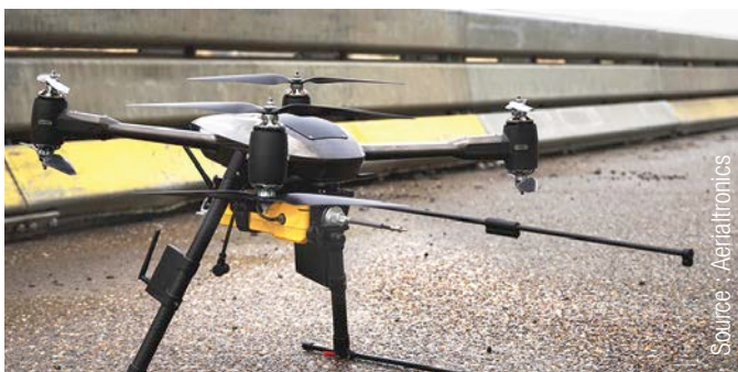
Fig. 24 Drone équipé d'un 'sniffer' pour le monitoring environnemental.
