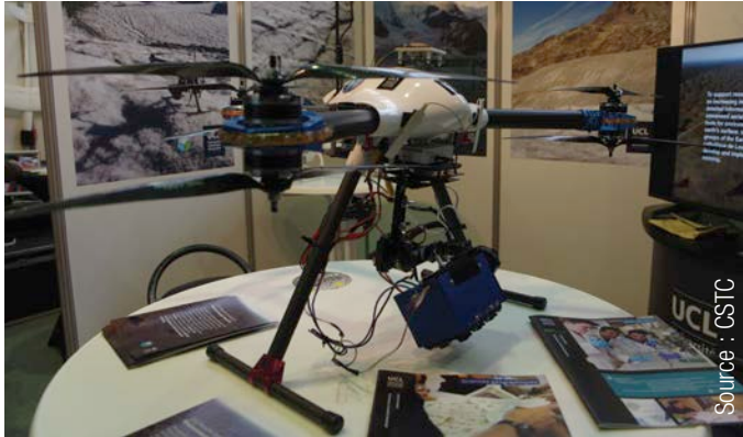
Fig. 18 Caméra multispectrale montée sur un multicoptère Y6 par l'Université catholique de Louvain.
