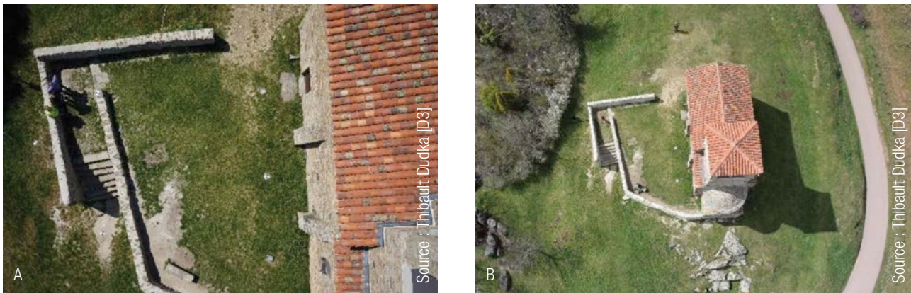
Fig. 14 Deux photos du même objet prises avec des focales différentes. A. Le téléobjectif permet de recentrer l'angle de vue sur des détails de l'objet. B. L'objectif grand-angle permet d'obtenir un champ large de la scène.
