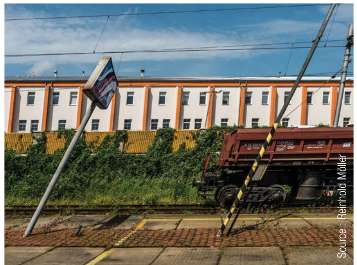
Fig. 13 Effet d'un obturateur électronique lorsque l'objet photographié est en mouvement par rapport au point de prise de vue.
