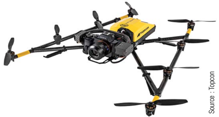
Fig. 9 Octocoptère de type H8, qui peut continuer à voler même si un des rotors s'arrête de fonctionner.
