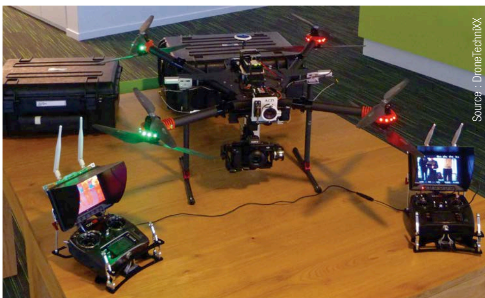
Fig. 29 Radiocommande avec écran de retour pour optimiser la prise de vue.
