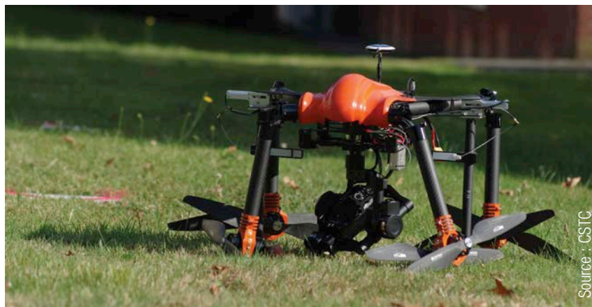
Fig. 12 Des bras repliables rendent le transport du drone plus facile.
