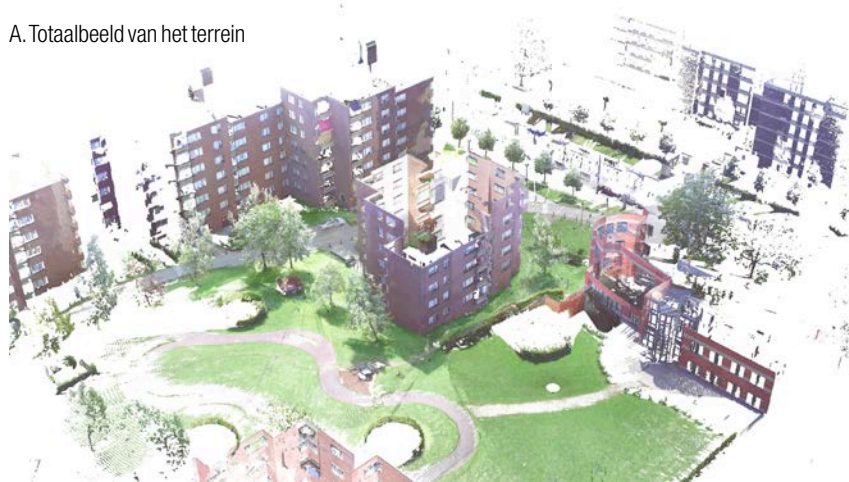
Afb. 2 Puntenwolk verkregen door middel van een opmeting met een laserscanner (bron van de afbeeldingen: WTCB / bron van het model: De Ceuster).
