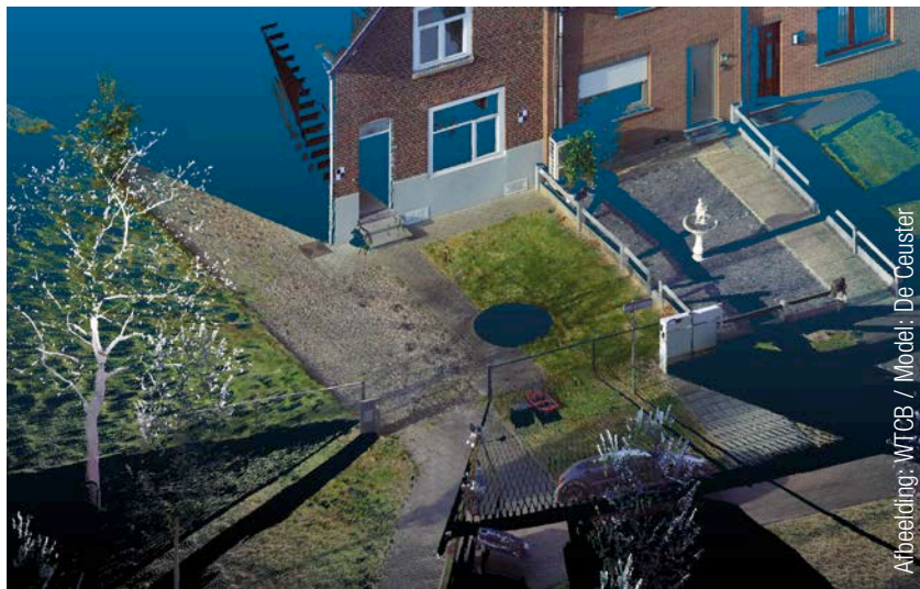
Afb. 10 Laserscanners zijn meetinstrumenten op basis van 'zichtlijnen': de objecten op de voorgrond werpen schaduwzones in de puntenwolk.
