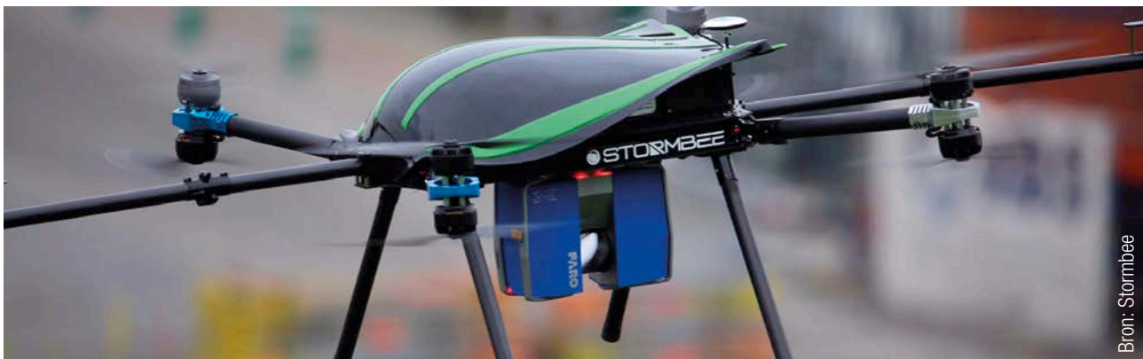
Afb. 47 De eerste 'compacte' lasergrammetrieoplossingen ingebouwd in drones.
