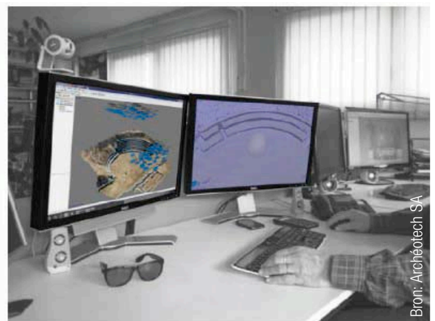
Afb. 23 De combinatie van scans van de binnen- en buitenkant van het gebouw maakt het mogelijk om de geometrie af te leiden met een ongekende mate van volledigheid.
