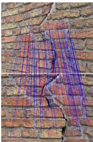
B. Automatische bepaling van homologe punten tussen de verschillende foto's van het object
