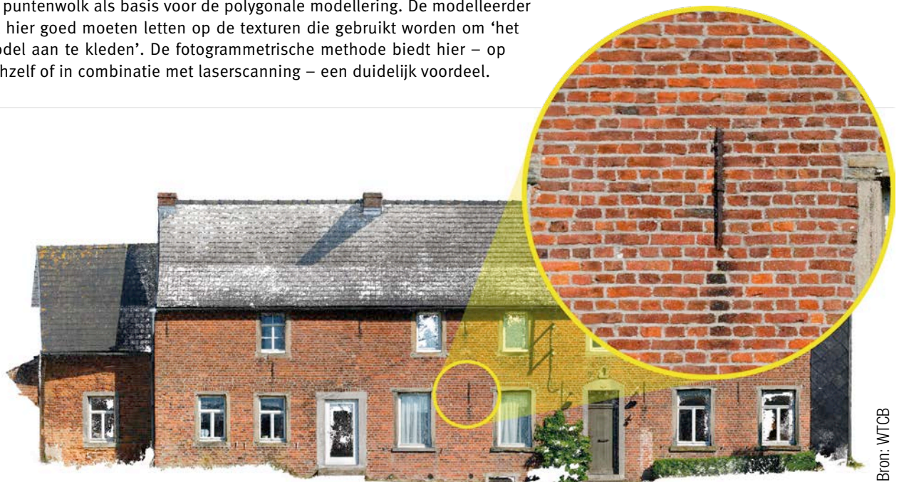
Afb. 33 Ortho-zicht van een puntenwolk met een zeer hoge resolutie afkomstig van de fotogrammetrische methode.
