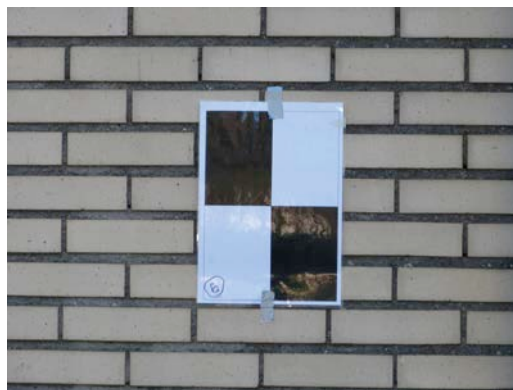
B. Voorbeeld van een richtpunt gebruikt bij het uitlijningsproces
