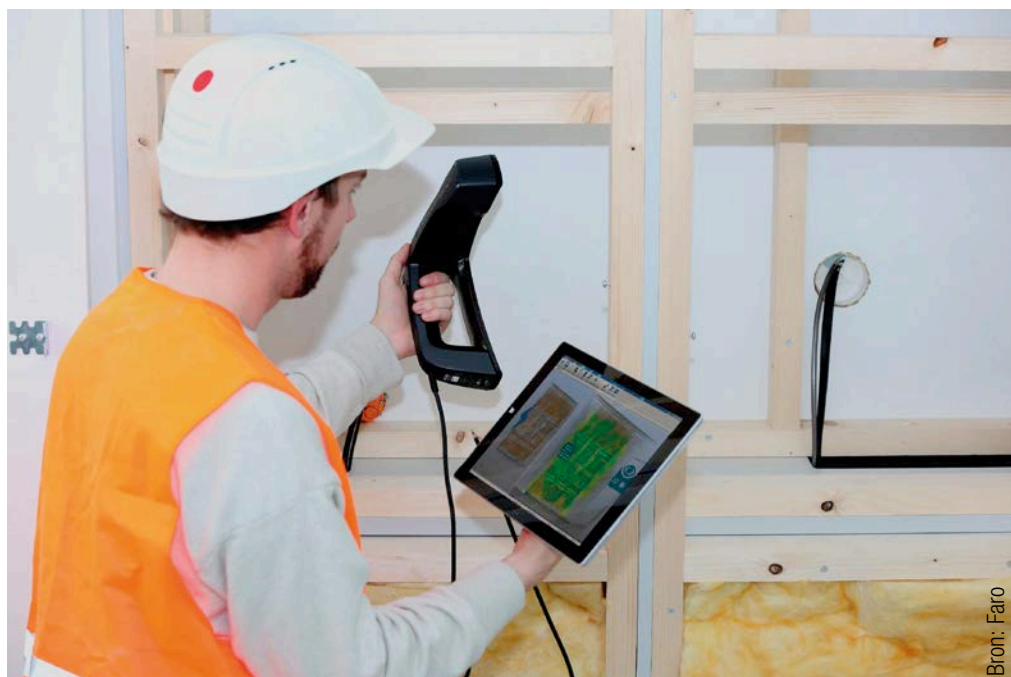
Afb. 18 3D-scanner met time-of-flight -camera voor binnenhuisopnamen in real time.
