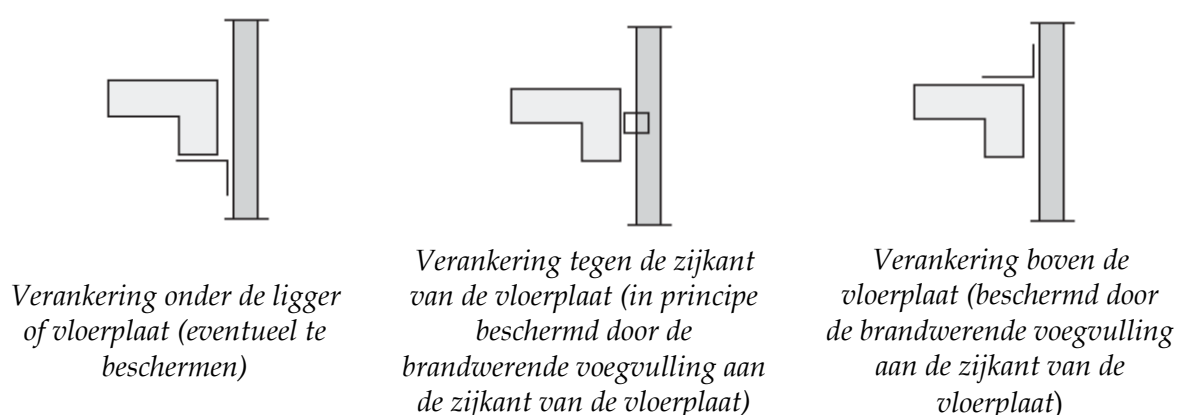
Afbeelding 17 - Principeschema voor de positionering van de bevestigingsankers van het skelet.
