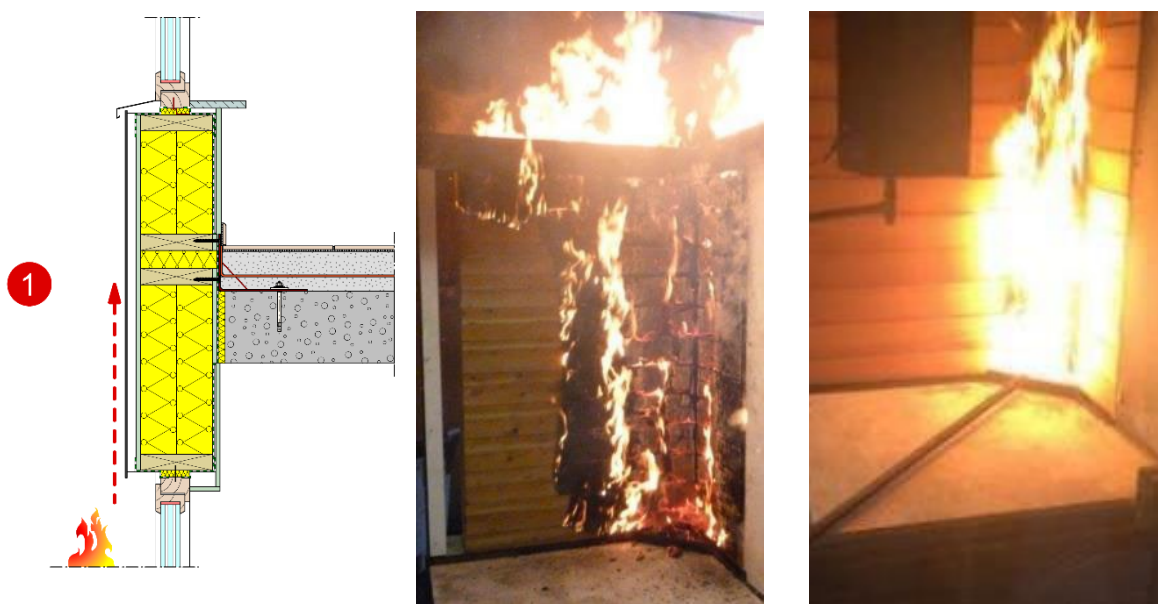
Afbeelding 9 – Brandoverslag via het oppervlak van de gevelbekleding (links) – Brandreactieproeven op een houten bebording (in het midden en rechts).
