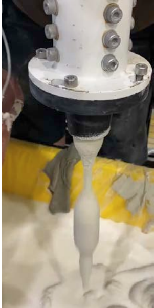
Afb 38 Principe van de Slugs-test ter bepaling van de vloedrempel van de mortel.
