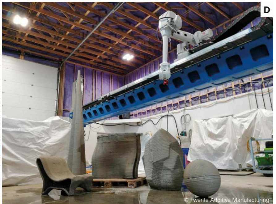
Afb. 6 Machine met een portaal (A), machine met hendels (B), machine met een robotarm met zes assen (C) en printer met negen assen met een op een portaal aangebrachte robotarm (D).
