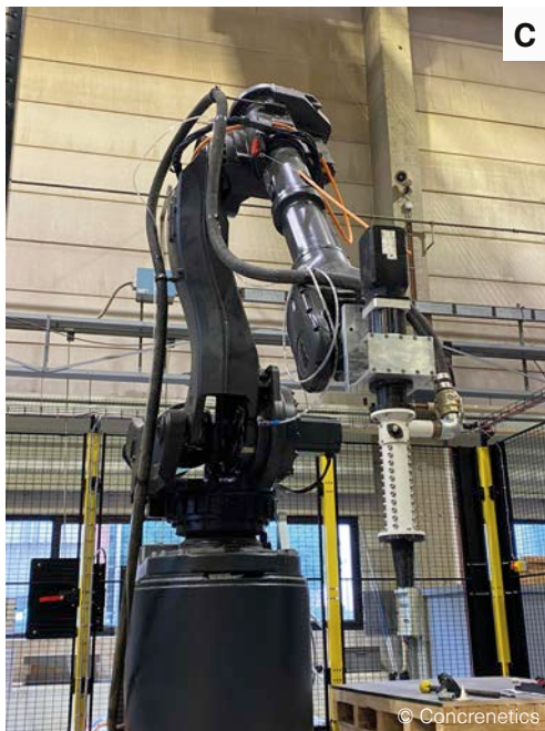
Afb. 6 Machine met een portaal (A), machine met hendels (B), machine met een robotarm met zes assen (C) en printer met negen assen met een op een portaal aangebrachte robotarm (D).
