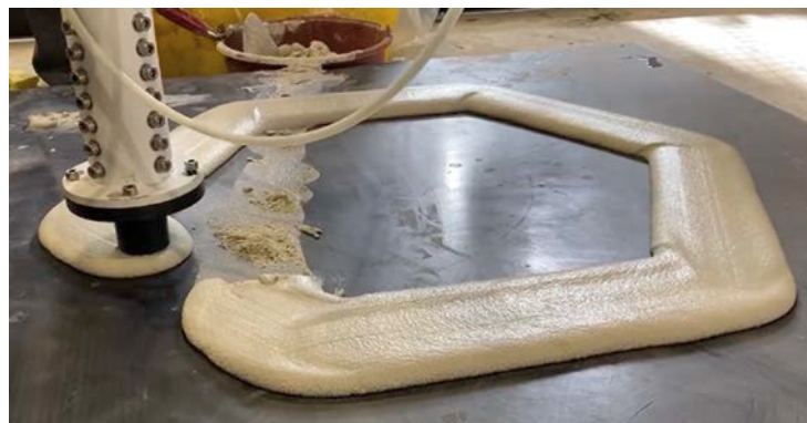
Afb. 37b 3D-printproeven die uitgevoerd werden bij Buildwise. Mengsel dat te vloeibaar geacht wordt (sterke inzakking, niet-bouwbaar mengsel).
