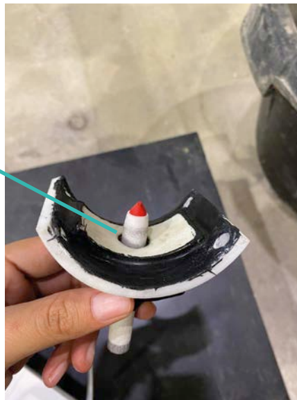
Afb. 37a 3D-printproeven die uitgevoerd werden bij Buildwise. Injectie van een bindingsversneller in de printkop die uitgerust is met een dynamische menger.
