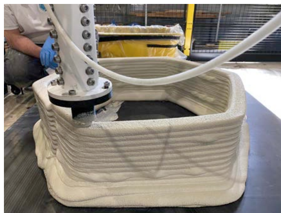
Afb. 37c 3D-printproeven die uitgevoerd werden bij Buildwise. Printbaar mengsel dat aanvaardbaar geacht wordt (verpompbaar, extrudeerbaar en bouwbaar).
