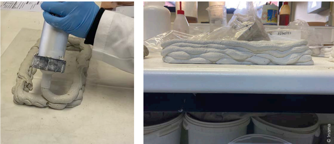
Afb. 39 Siliconenpistool, gebruikt om de extrudeerbaarheid van het printbare mengsel te testen (links) en voorbeeld van lagen die met dit pistool geprint werden (rechts).
