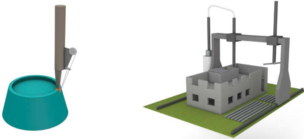
Afb. 4 Het Contour Crafting -proces (links) en principe van het bouwen op grote schaal met dit procedé (rechts) [K1].
