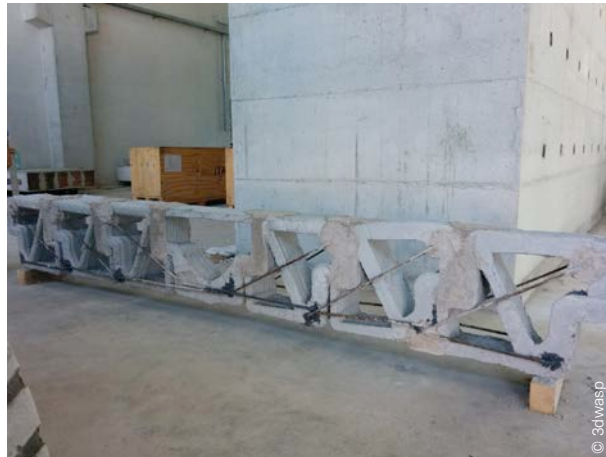
Afb. 30 Balk die gewapend werd door het assembleren van externe wapeningsstaven.
