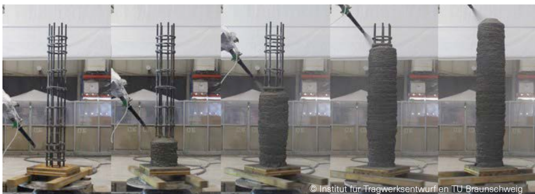
Afb. 29 Productiestappen van een gewapende kolom met de SC3DP-methode.
