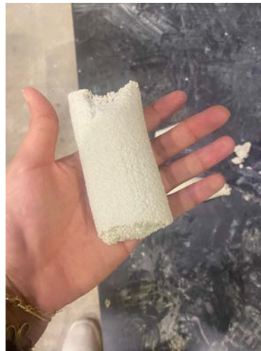
Afb. 37d 3D-printproeven die uitgevoerd werden bij Buildwise. Mengsel dat te stevig geacht wordt (niet-extrudeerbaar).
