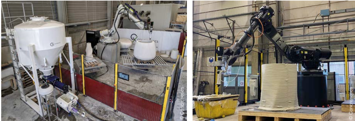
Afb. 42 One-X Industry -systeem (links) en voorbeeld van een element dat met dit systeem geprint werd bij Buildwise (rechts).
