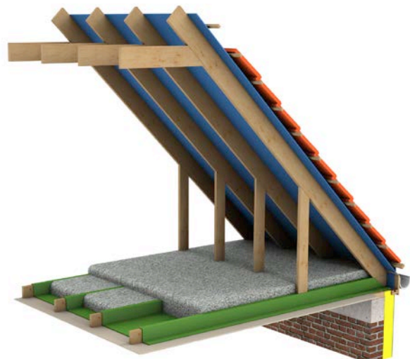
Afb. 2 Isolatie vanaf de bovenkant (3D-weergave).
