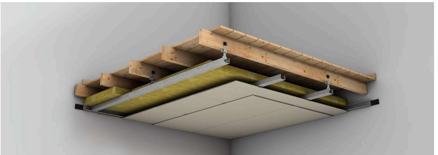
Afb. 3 Verlaagd plafond met akoestische (plafond)hangers en dubbele afwerking.
