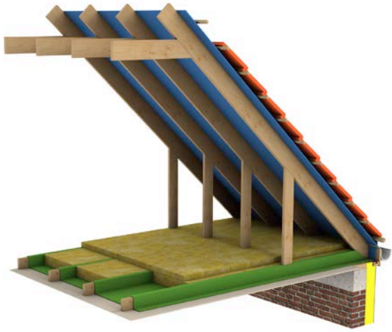
Afb. 1 Isolatie vanaf de bovenkant (3D-weergave).
