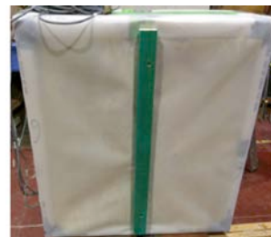
Vastgeniet dampscherm met houten stijlen (ideaal geval)
