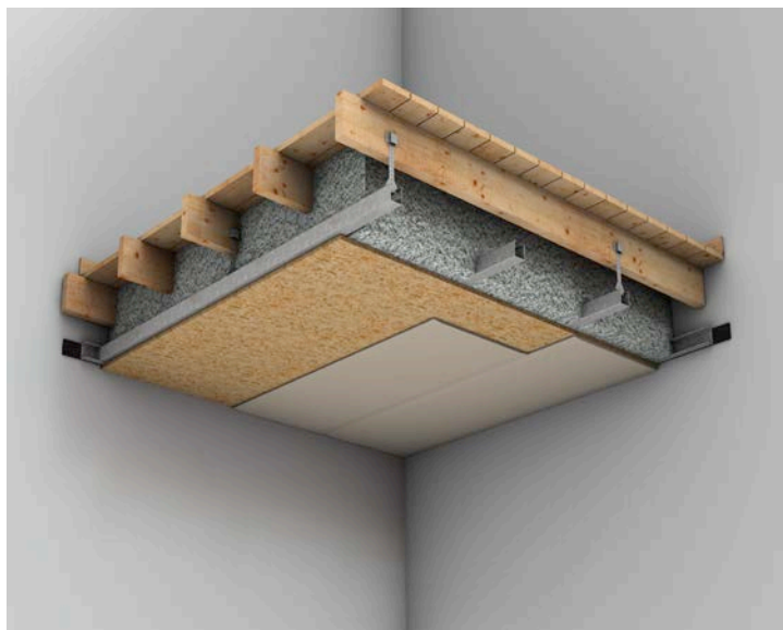
Afb. 1 Verlaagd plafond met akoestische dozen (3D-weergave).
