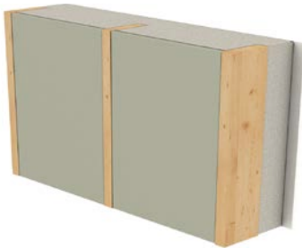
Afb. 3 Houtskelet, toepassing langs de buitenkant (3D-weergave). Zorg ervoor dat de dikte langs de buitenkant meer dan 60 mm bedraagt en dat de krimp voldoende klein is.
