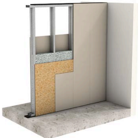
Afb. 1 Dubbel metalen skelet (3D-weergave).
