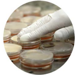
Afb. 1 Gevoeligheidstest voor schimmels volgens de norm NBN EN ISO 846.
