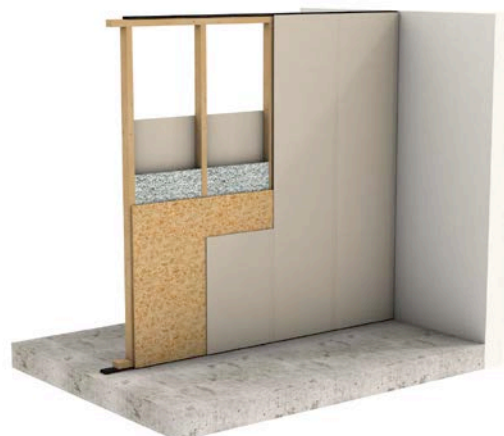
Afb. 2 Enkelvoudig houten skelet (3D-weergave).
