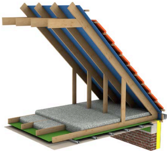
Afb. 1 Isolatie vanaf de onderkant (3D-weergave).
