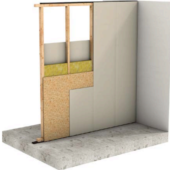
Afb. 2 Enkele scheidingswand met een houtskelet (3D-weergave).
