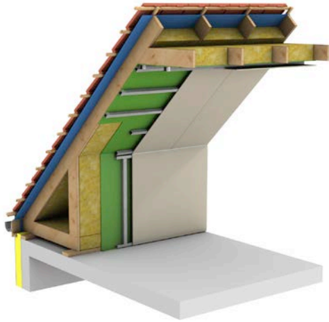
Afb. 1 Halfstijve isolatie tussen sporen (3D-weergave).
