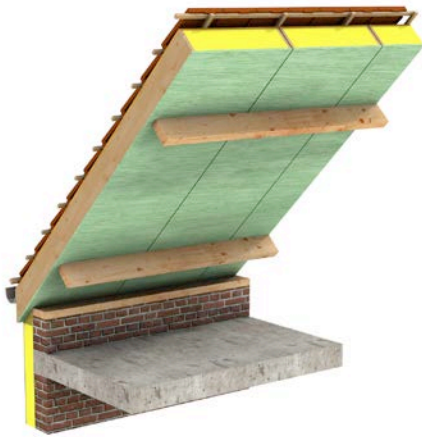
Afb. 1 Dakisolatie met behulp van prefab-elementen: plaatsing in de richting van de helling (3D-weergave).
