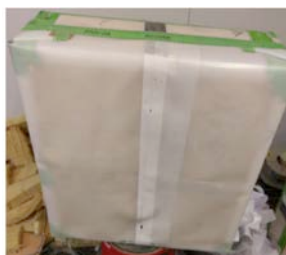
Overlappend dampscherm met dubbelzijdige tape
