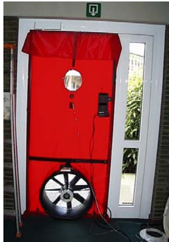
Afb. 8 Blazende deur voor de pressurisatieproef in het gebouw.
