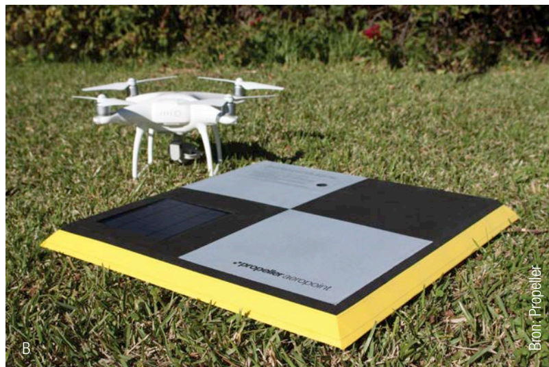
Afb. 38 Ruimtelijke referentie van opmetingen. A. Manuele verzameling van gps-punten. B. Een 'slim' richtpunt.
