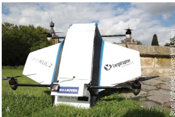
Afb. 10 Er zijn heel wat soorten drones die niet behoren tot de categorie van de vaste vleugels of van de roterende vleugels. A. Hybride drone die een hoge verplaatsingssnelheid combineert met de mogelijkheid om verticaal op te stijgen. B. Biomimetica aan de hand van een 'ornithopter'-drone.
