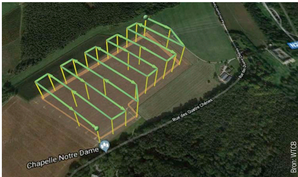
Afb. 30 Programmatie van de vlucht door middel van gps-punten.
