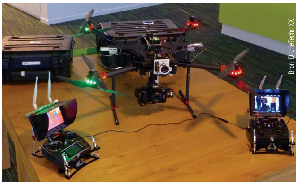
Afb. 29 Afstandsbediening met feedbackscherm om de kwaliteit van de beeldopname te verbeteren.
