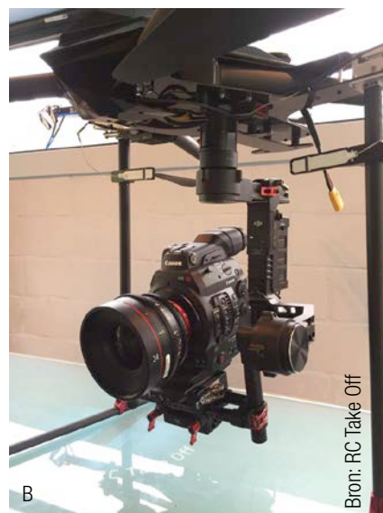
Afb. 16 Er is een grote verscheidenheid aan gimbals en aan hulpmiddelen die de camera 'dragen' en zorgen voor de stabiliteit ervan. A. Gimbal met geïntegreerde camera onder de drone. B. Professionele gimbal waarop een zeer zware filmcamera gemonteerd kan worden, die onder de drone bevestigd wordt.
