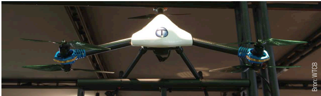
Afb. 61 De redundantie van de motoren.
