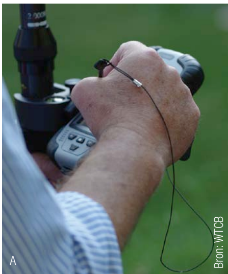
Afb. 38 Ruimtelijke referentie van opmetingen. A. Manuele verzameling van gps-punten. B. Een 'slim' richtpunt.
