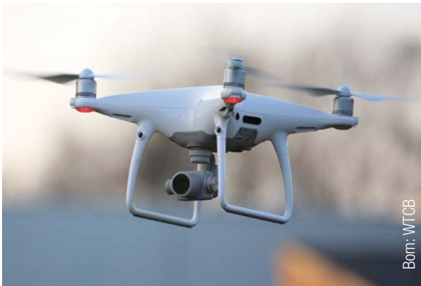
Afb. 8 Een quadcopter is een erg populair type drone dankzij zijn eenvoud. Voorbeeld van een 'vliegklaar' model.
