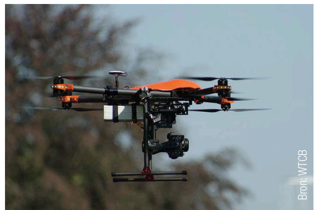
Afb. 4 Gebruik van een drone voor de fotogrammetrische opmeting van een gebouw.
