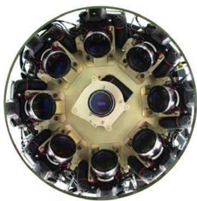
Afb. 20 Specifieke samenstelling van reflexcamera's om de fotogrammetrische opmeting te optimaliseren. Door zijn gewicht is dit type materiaal niet compatibel met een standaard multicopter.
