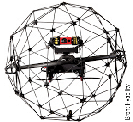
Afb. 27 Beschermende bol waardoor het voor de drone mogelijk is om zich in afgesloten ruimten te verplaatsen.
