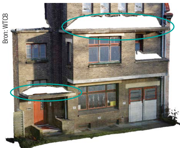
Afb. 34 Nadeel van fotogrammetrie op basis van foto's genomen vanop de grond: de zones die niet goed zichtbaar zijn op de foto's (daken, balkons ...) zullen resulteren in 'gaten' in de gereconstrueerde 3D-modellen.
