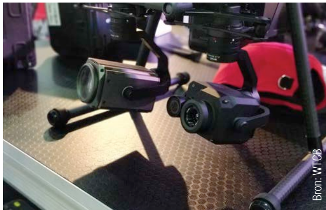
Afb. 21 Drone uitgerust met twee verschillende instrumenten: een camera met zoomfunctie en een thermische camera.
