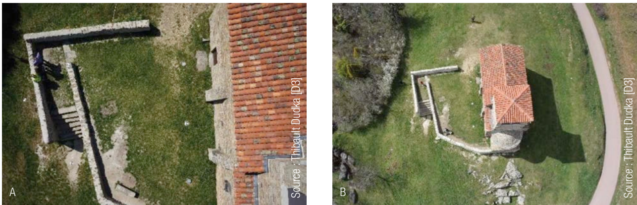
Afb. 14 Twee foto's van hetzelfde voorwerp die genomen werden met twee verschillende brandpuntsafstanden. A. Het teleobjectief maakt het mogelijk om de beeldhoek te focussen op de details van het voorwerp. B. Het groothoekobjectief maakt een breder gezichtsveld mogelijk.
