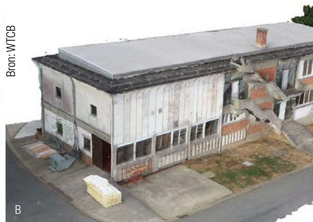
Afb. 36 Twee zeer uiteenlopende 3D-reconstructies op basis van het gevolgde opnameprotocol. A. Alleen NADIR-foto's. B. Combinatie van NADIR-foto's en schuine foto's.
