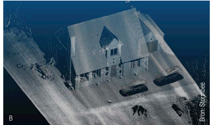
Afb. 40 Het gebruik van een laserscanner die gemonteerd is op een voorwerp in beweging vereist een correctie van de metingen. A. Resultaat van de opmeting met de laserscanner zonder correctie. B. Zelfde scan na correctie.
