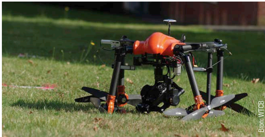
Afb. 12 Plooibare armen die het transport van de drone vereenvoudigen.
