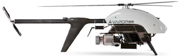
Afb. 6 De helikopter is een subtype van een drone met roterende vleugels. Merk op dat er een staartrotor aanwezig is die ervoor zorgt dat het toestel niet rond zijn as begint te draaien.
