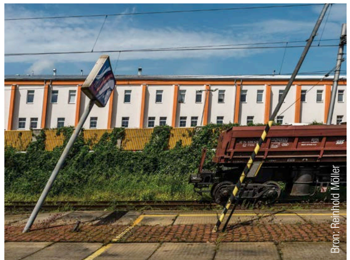
Afb. 13 Effect van een elektronische sluitter wanneer het gefotografeerde beeld in beweging is ten opzichte van het punt van waar de foto genomen werd.
