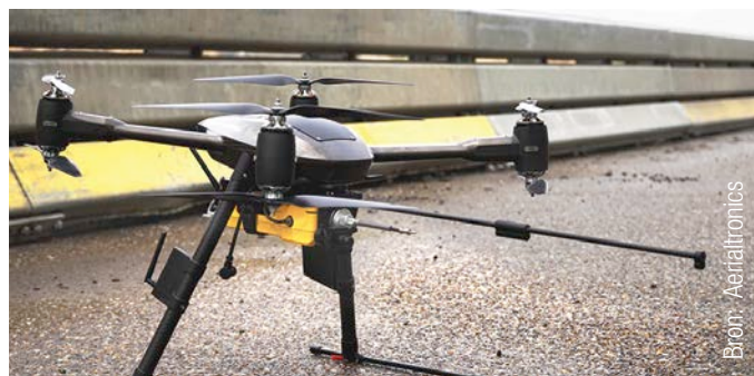
Afb. 24 Drone uitgerust met een 'sniffer' voor milieutoezicht.
