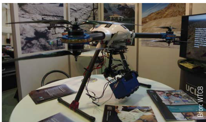
Afb. 18 Multispectrale camera die door de Katholieke Universiteit Leuven gemonteerd werd op een Y6-multicopter.
