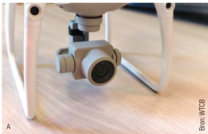
Afb. 16 Er is een grote verscheidenheid aan gimbals en aan hulpmiddelen die de camera 'dragen' en zorgen voor de stabiliteit ervan. A. Gimbal met geïntegreerde camera onder de drone. B. Professionele gimbal waarop een zeer zware filmcamera gemonteerd kan worden, die onder de drone bevestigd wordt.
