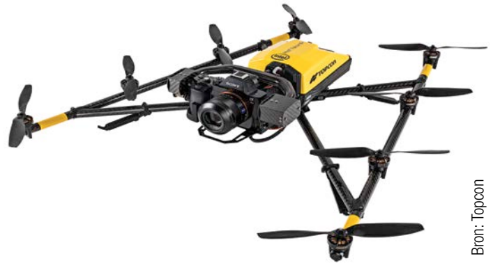
Afb. 9 Een octocopter type 'H8' die kan blijven vliegen zelfs wanneer één van de rotors stopt met werken.
