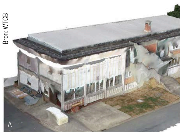
Afb. 36 Twee zeer uiteenlopende 3D-reconstructies op basis van het gevolgde opnameprotocol. A. Alleen NADIR-foto's. B. Combinatie van NADIR-foto's en schuine foto's.
