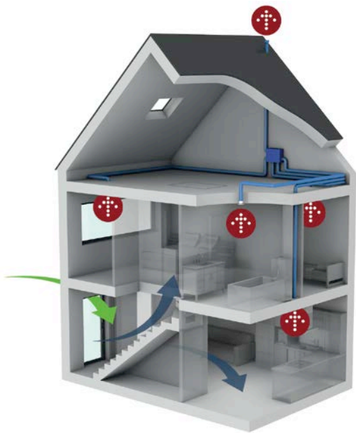
Afb. 16B 3D-schema van het systeem C hal centraal in een huis met twee verdiepingen.
