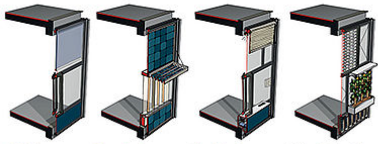
Afb. 59 Multifunctionele gevel van de universiteit van Delft (bron: TU Delft) [161].
