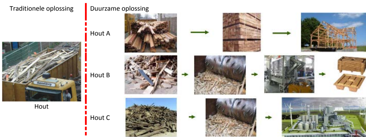
Afb. 42 Sortering van houtafval op de bouwplaats (bron: Dusseldorp) [122].
