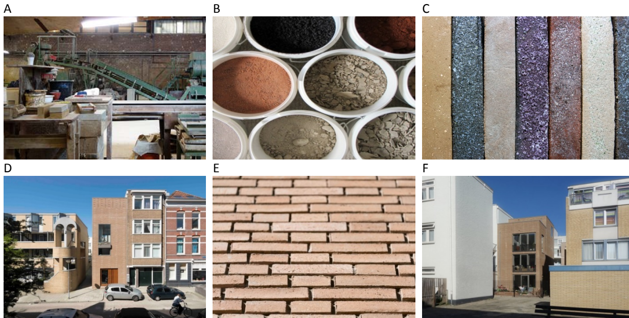
Afb. 50 Bakstenen, geproduceerd op basis van sloopmateriaal (bron: StoneCycling) [155].
