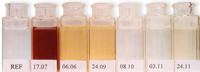
3 | Coloration de l'eau en provenance d'une toiture plate munie d'une membrane d'étanchéité
