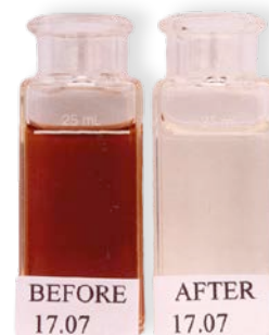
4 | Effet d'un filtre à charbon actif sur une eau de pluie brune avant (à gauche) et après (à droite) le traitement
