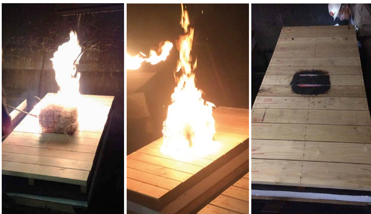
Illustration de l'essai du début (inflammation du panier rempli de laine de bois) à la fin (endommagement limité du revêtement en bois).
