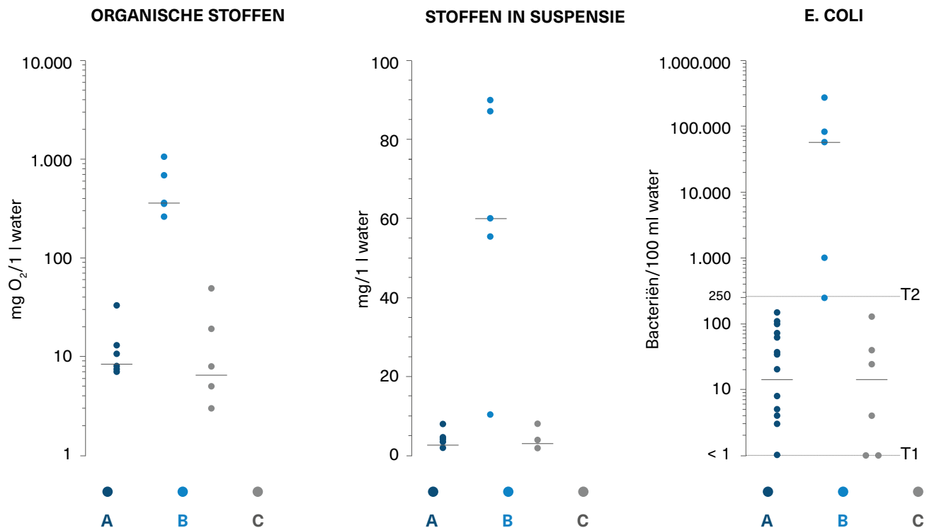
2 Vergelijking van de concentraties organische stoffen, stoffen in suspensie en E. colibacteriën voor de proefstalen van hemelwater (A), onbehandeld grijswater (B) en behandeld grijswater (C). De horizontale lijn in elke kolom geeft de mediaan weer, d.w.z. de waarde die de onderste helft van de proefstalen scheidt van de bovenste helft.
