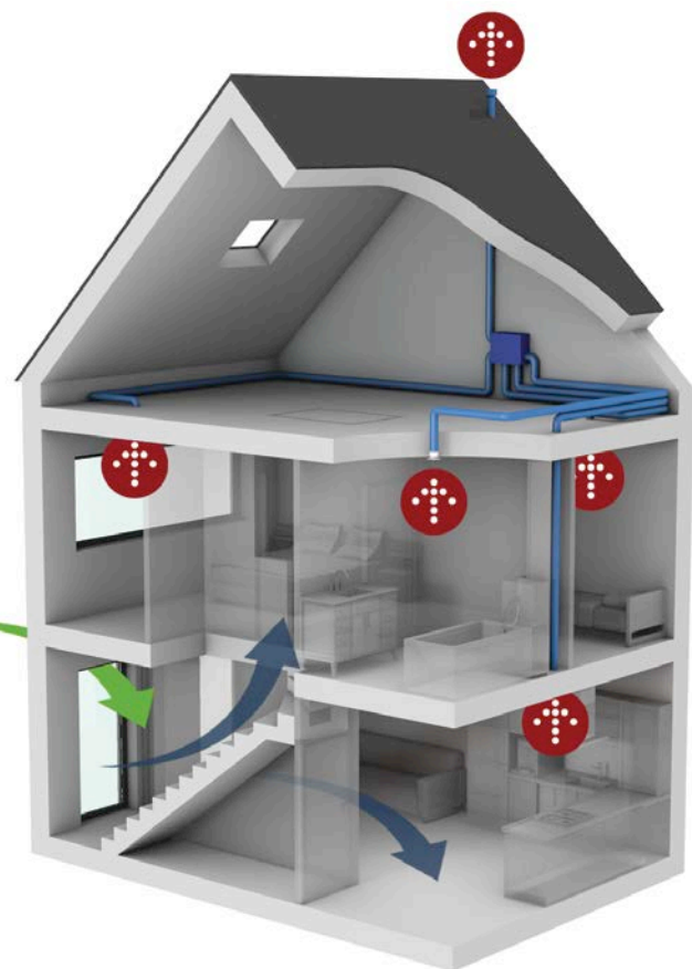
2 | Illustratie van de op een systeem C gebaseerde variant, met natuurlijke toevoer via de inkomhal.
